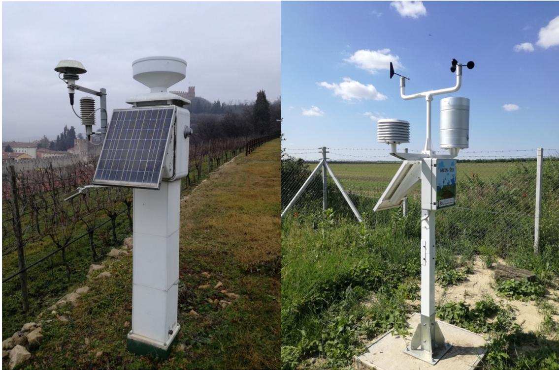
Figura 8 Differenti modelli di stazioni meteo. Da notare in particolare la differente forma dei pluviometri (a sinistra un collettore con bocca da  $1000\text{cm}^2$ , a destra invece  $500\text{cm}^2$ )
