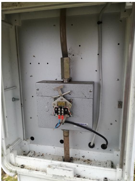
*Figura 6 Pluviometro a bascula: è visibile il pendolo esterno alla bascula (con il magnete) e i contatti che permettono di inviare il segnale quando il reed switch viene attivato*
