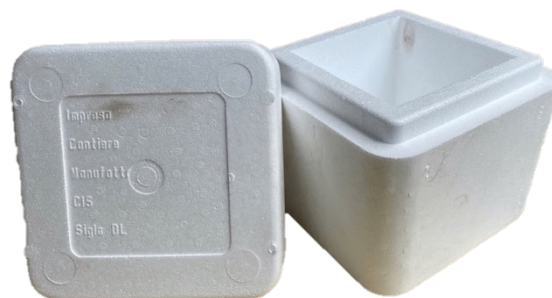
Figura 98: casseri cubici in polistirolo, lato 150 mm
