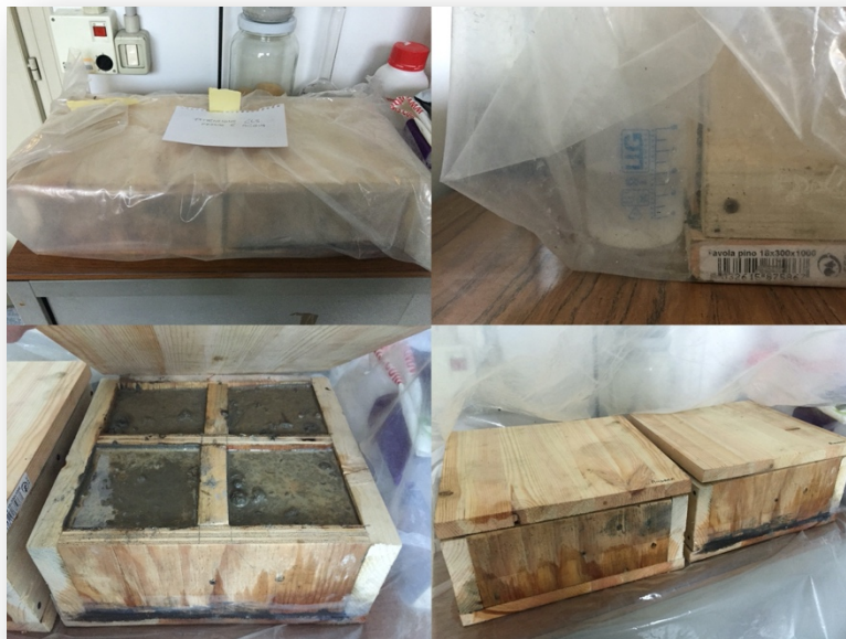
Figura 117: casseri, provini e becker acqua
