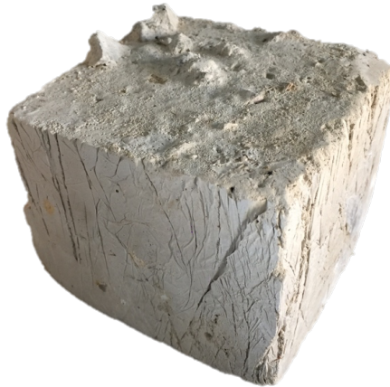
Figura 116: provino con disomogeneità in evidenza
