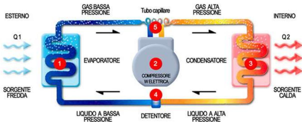
Figura 34 - Schema funzionamento pompa di calore
