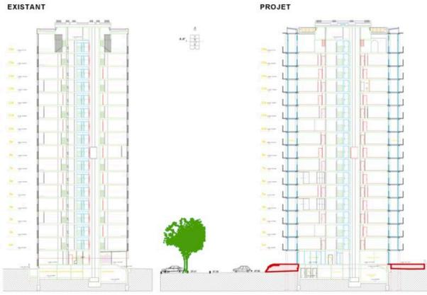
39. Sezione schema di progetto dell'intervento sull'edificio in Parigi.
