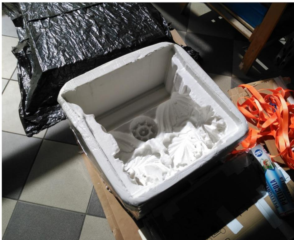
Figura 55: Realizzazione calco nel quale verrà realizzata la riproduzione con resine aventi la stessa percezione al tatto dell'oggetto originale
