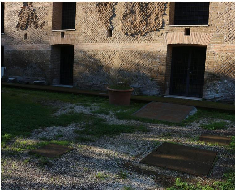
Dislivello dell' Antiquarium superiore di 5 cm risolto per mezzo di una rampa negli accessi che si integra con il contesto.
