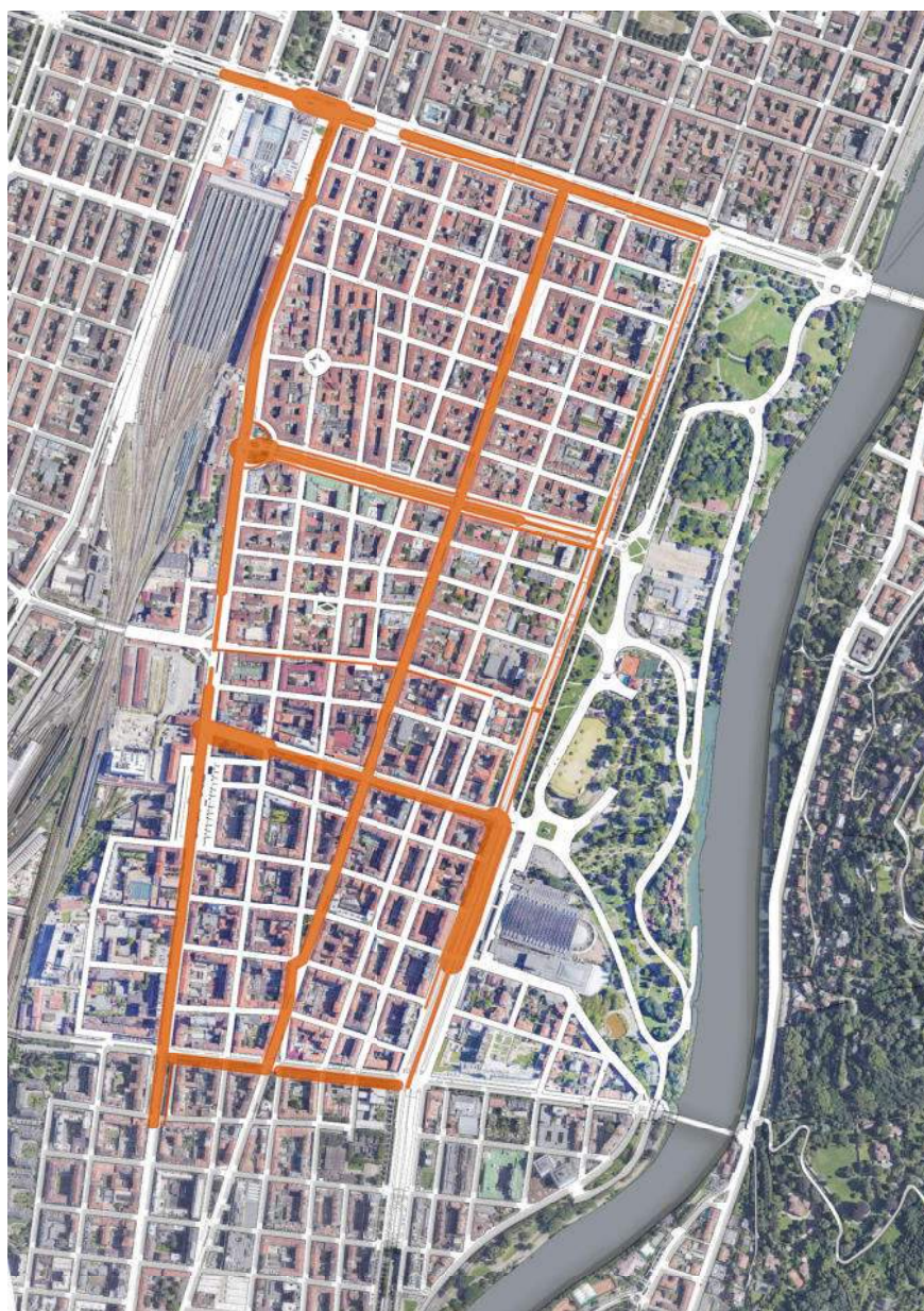
Fig. 1 - Rappresentazione per ampiezza lineare della capacità complessiva dei principali archi stradali del quartiere. (fonte dati: http://www.geoportale.piemonte.it/traffico-giornaliero-medio-2018-su-elemento-stradale-BDTRE ).
