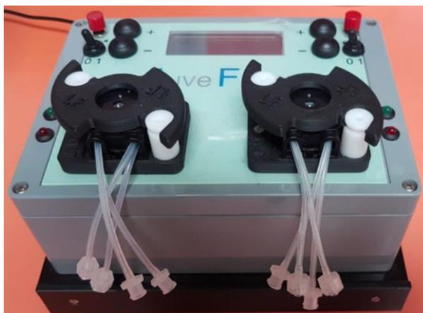
**Fig. 34: Pompa peristaltica LiveFlow.**
