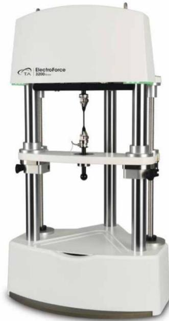
**Fig. 29: Dispositivo Bose ElectroForce 3200 utilizzato per i test a trazione ciclici [67].**
