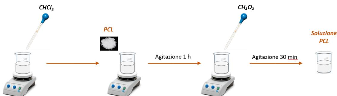
**Fig. 25:** Rappresentazione schematica della preparazione della soluzione di PCL.
