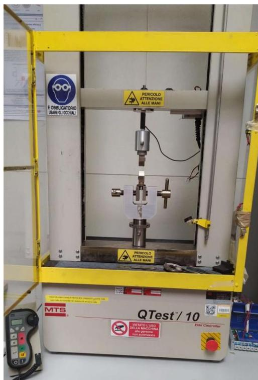
**Fig. 28: Dispositivo MTS MTS QTest/10 utilizzato per i test di trazione statica.**
