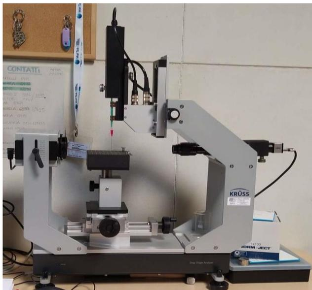
Fig. 32: Dispositivo KSV CAM 200 utilizzato per l'angolo di contatto.
