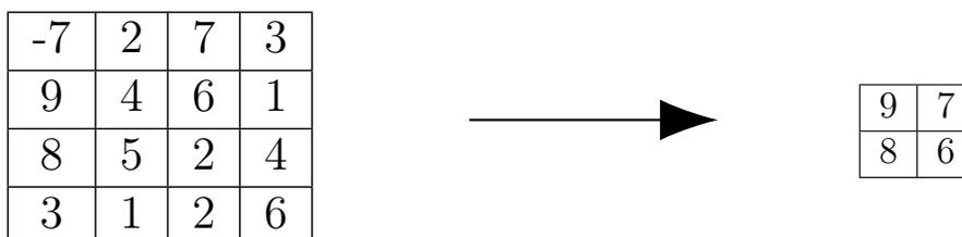
**Figura 2.5:** Applicazione del Max-Pooling considerando una dimensione 2x2.
