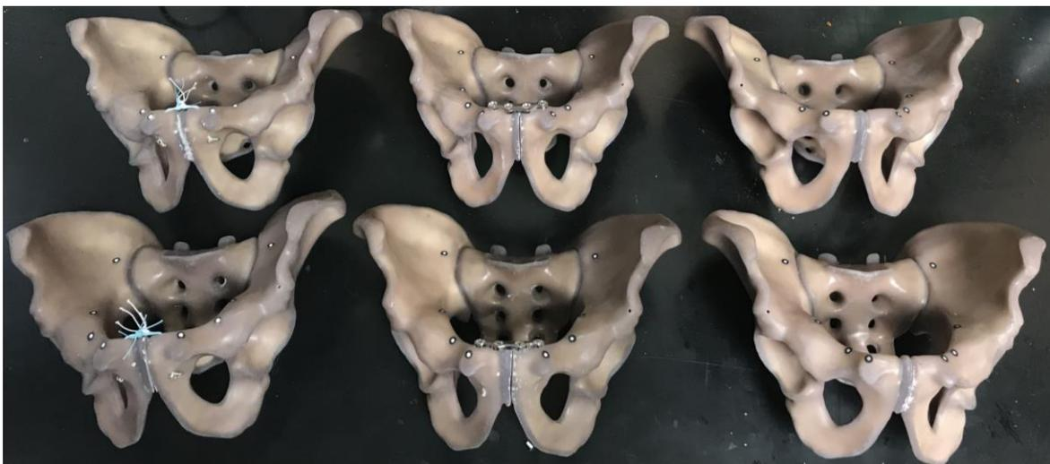
*Fig. 2.9 Campioni pre- test meccanico su cui sono stati applicati i marker*
