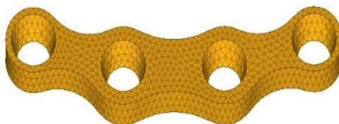
Fig. 2.26 Modello agli elementi finiti della placca a quattro fori
