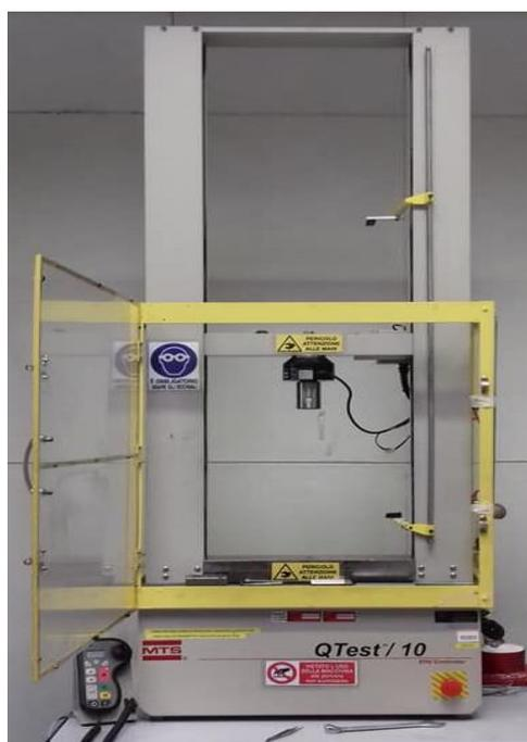
Fig. 2.12 Macchina MTQ *QTEST ELITE 10* presente presso il Dipartimento di Ingegneria Meccanica e Aerospaziale del Politecnico di Torino
