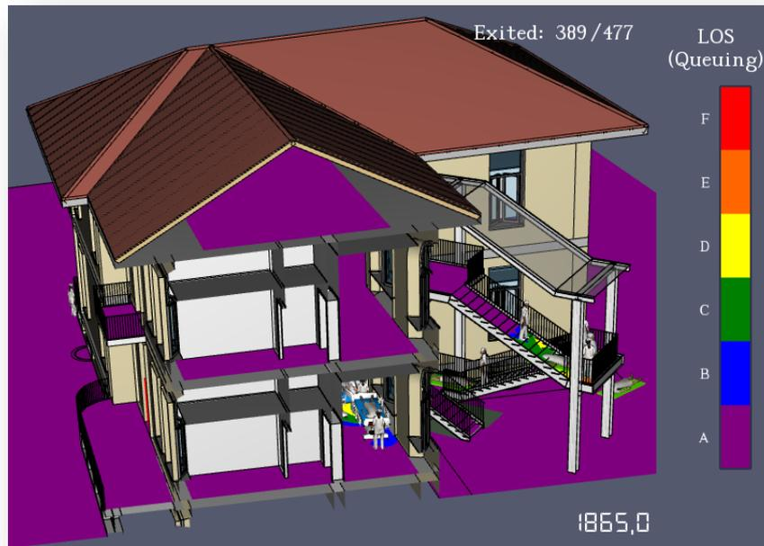
Figura 69 - Rappresentazione del LoS (Queuing) per la scala Esterna Sud
