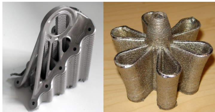
Figura 1.7: (sx) Supporto a 45° prodotto con SLM [12]. (dx) Girante prodotta con LENS [13]
