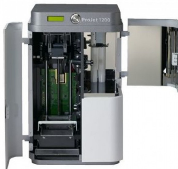
Figura 2.10: stampante DLP ProJet 1200: a sinistra la camera di costruzione, a destra il forno per post trattamento [59]
