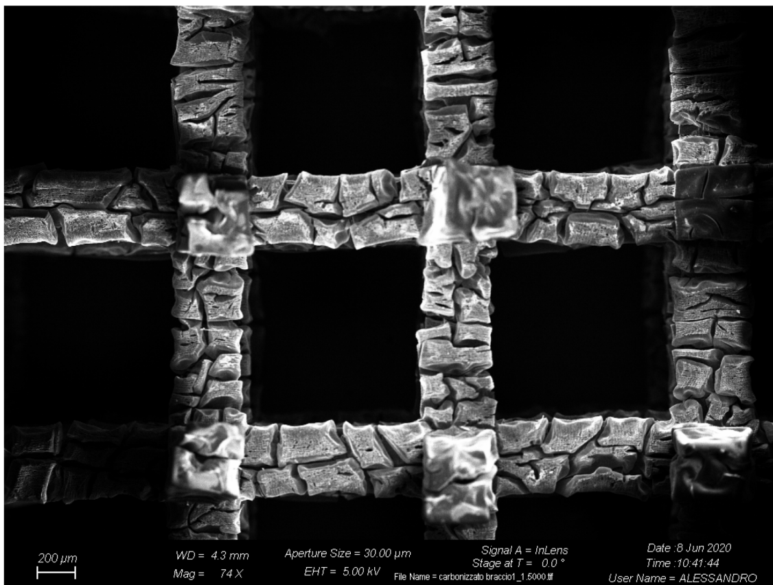
Figura 5.14: campione 1:1,5 pirolizzato, vista dall'alto
