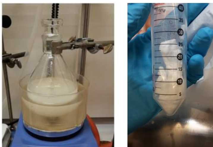
Figura 4: set-up (a) e prodotto finale (b) della reazione di metacrilazione.
