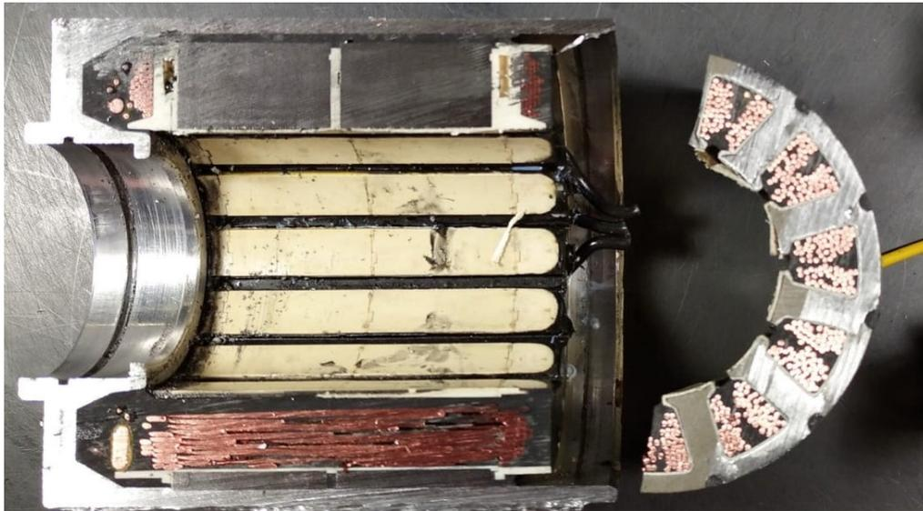
Figura 2.5. Motore AMK - Sezione trasversale e longitudinale dello statore
