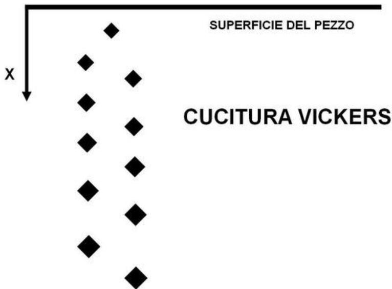
Figura 3.9. Cucitura di durezza Vickers [Granit Engineering]
