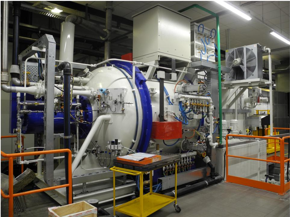
Figura 2.1. Forno sotto vuoto con spegnimento in olio e in gas
