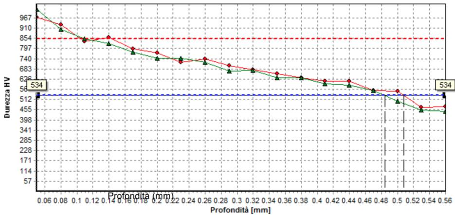
Figura 3.11. Grafico profondità di nitrurazione sulla dentatura
