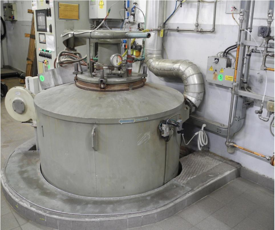
Figura 3.2. Forno di nitrurazione gassosa
