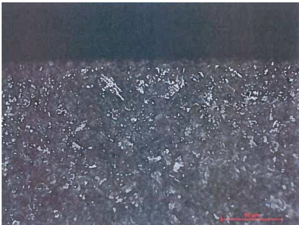
Figura 2.7. Carburazione 16NCD13
