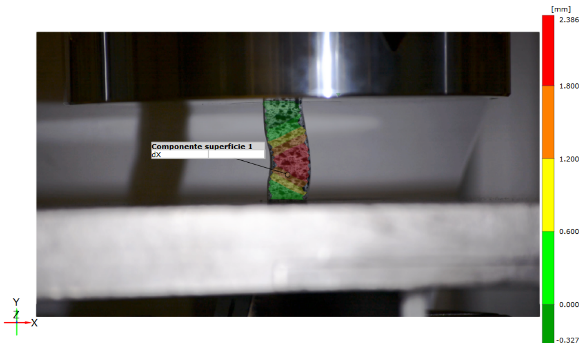
Figura 6.27. Spostamento trasversale di un provino lungo 40 mm.
