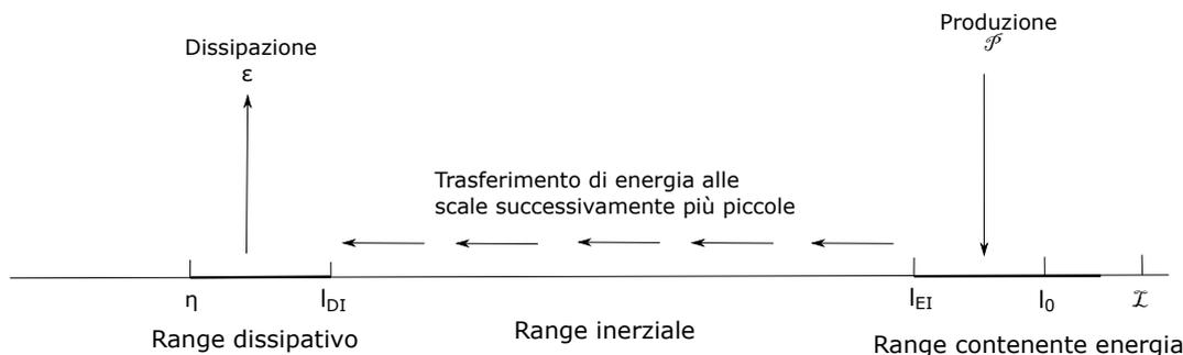
Figura 2.6: Rappresentazione schematica della cascata energetica a numeri di Reynolds molto alti; nel diagramma si osserva come l'energia viene prodotta nelle strutture più grandi, trasferita progressivamente a strutture sempre più piccole, e da queste infine dissipata; immagine tratta da [6].
