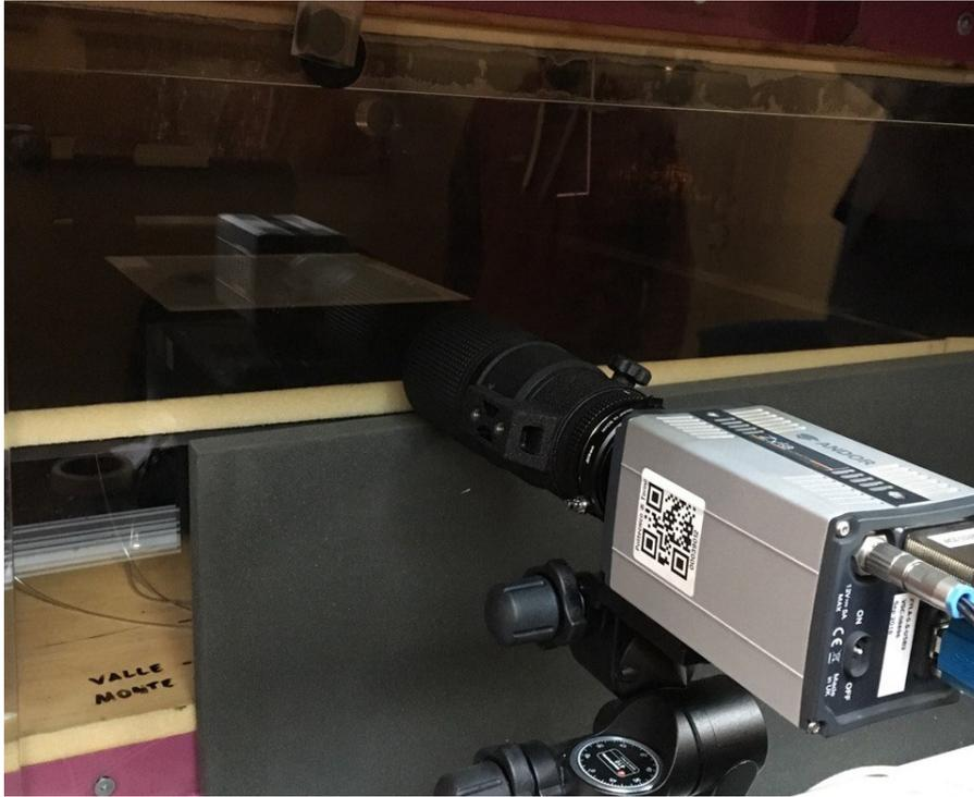
FIGURA 4.6: Camera sCMOS utilizzata durante le prove.
