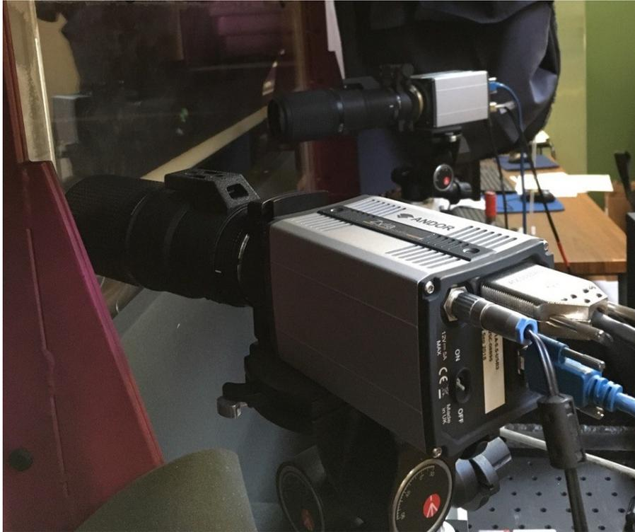
FIGURA 4.11: Configurazione delle camere adottata durante l'esperimento di Stereo-PIV.
