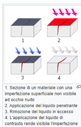
Figura 6.3 -Procedura per effettuare test liquidi penetranti
