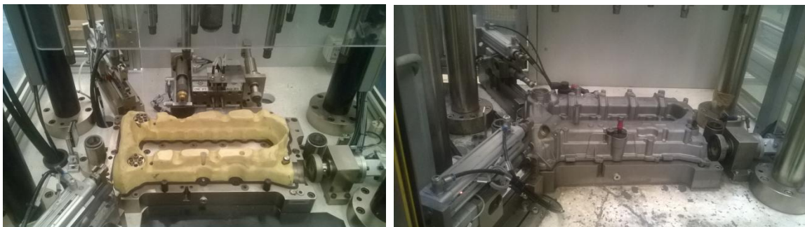
Figura 4.7 - Stazione di prova di tenuta su sovratesta assemblata
