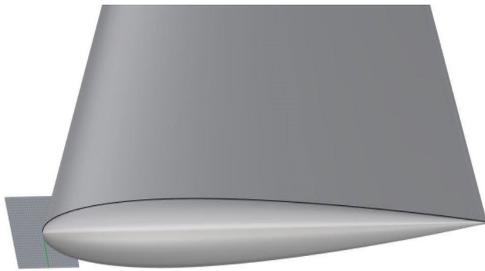
Figura 5.2: Vista 3D di ala finita con bordo di estremità arrotondato
