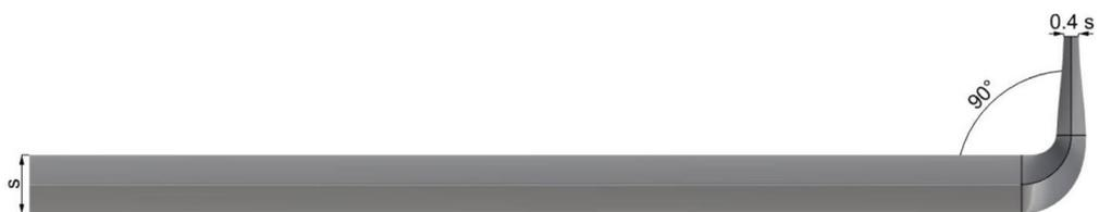
Figura 5.6: Caratteristiche geometriche dell'ala con il winglet, vista frontale
