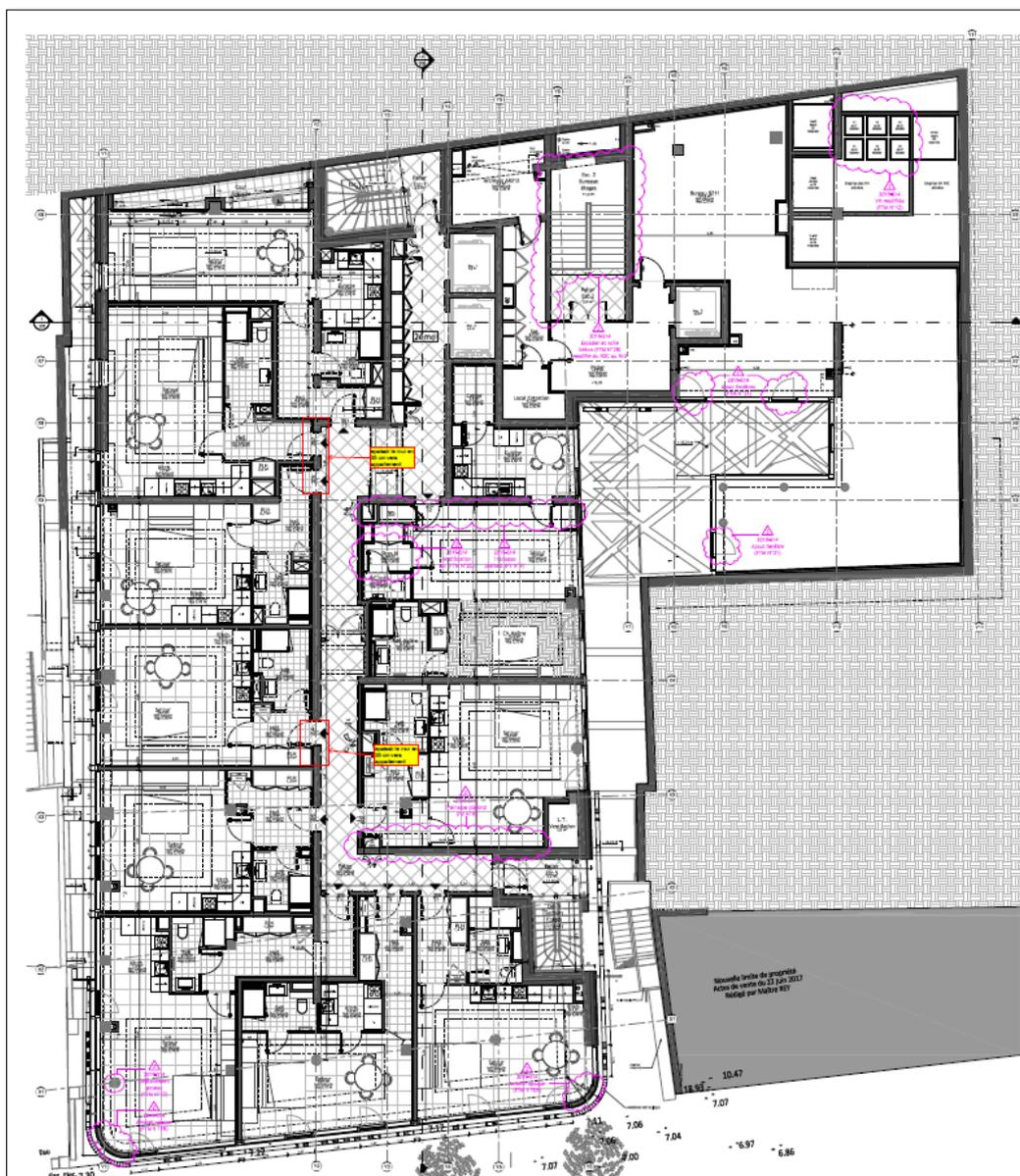
**Figura 45: Pianta architettonica, secondo livello (piano tipo per appartamenti di superficie monolocale)**
