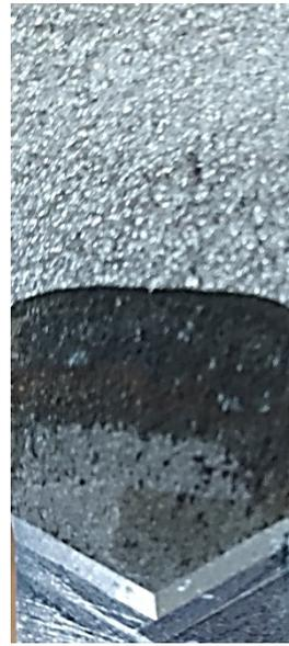
*Figura 5.11 - Superficie di frattura per il provino 315-1, nel quale la misurazione della cricca di fatica è avvenuta sia con il metodo ottico che con quello PD*
