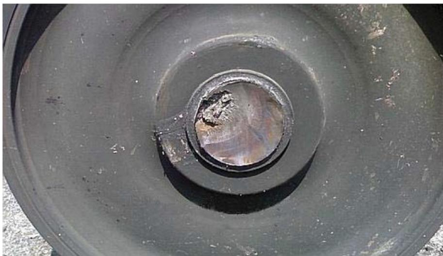
*Figura 1.1 - Assile ferroviario rotto, disastro di Viareggio, 2009*
