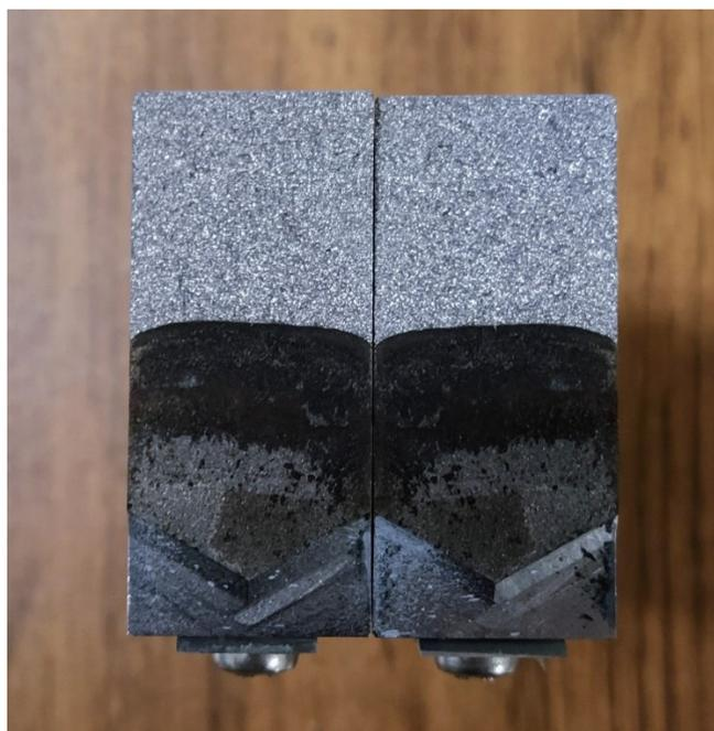
Figura 3.8 - Superficie di frattura in seguito alla prova per la determinazione del  $K_{IC}$
