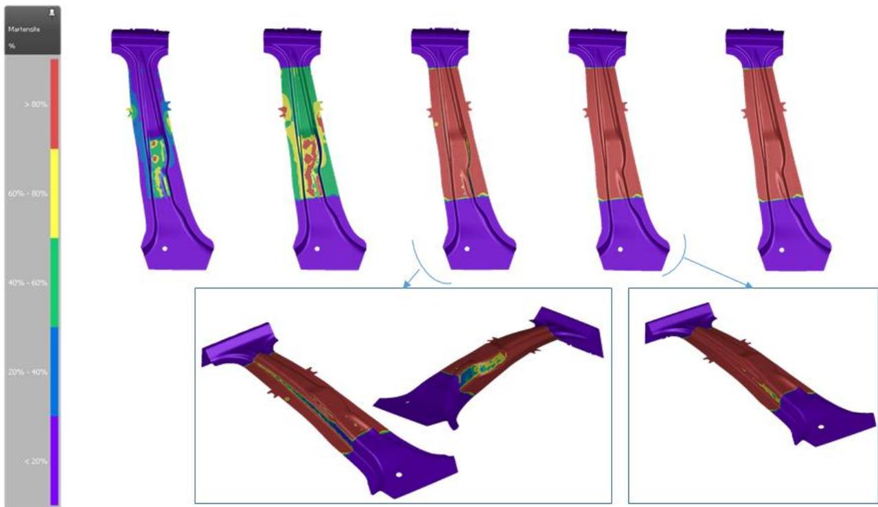
Figura 6.36 Mappa della martensite: a) Dopo 0,5 sec; b) Dopo 1 sec; c) Dopo 2 sec; d) After 3 sec; e) Dopo 6 sec
