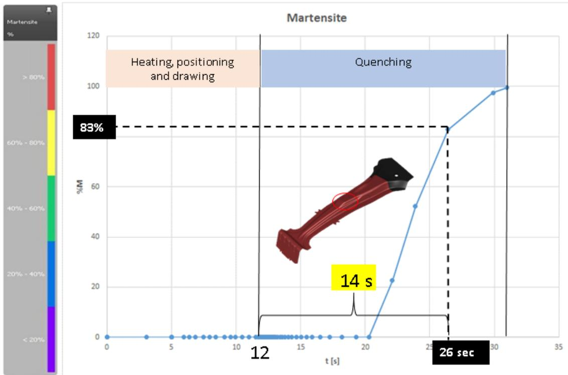
Figura 6.14 Andamento della percentuale di martensite ottenuta in funzione del tempo
