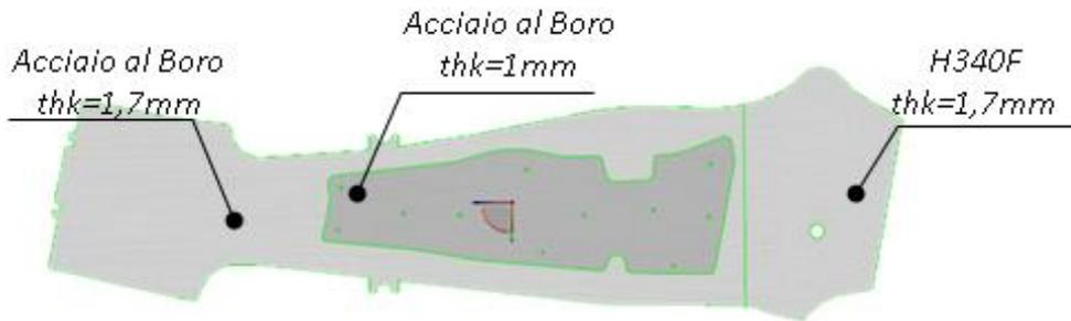
Figura 6.2 Struttura del blank nel caso studio 1 Partial Hardening
