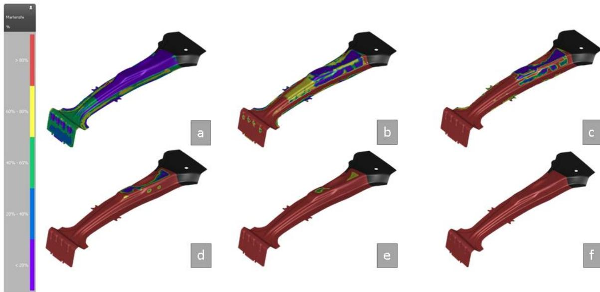
*Figura 6.13* Mappa della martensite durante il processo di tempra in varie fasi: a) Dopo 2 sec; b) Dopo 4 sec; c) Dopo 5 sec; d) Dopo 8 sec; e) Dopo 11 sec; f) Dopo 14 sec
