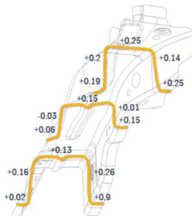
**Figura 6.51** Ritorno elastico in alcune sezioni caratteristiche del componente formato con SmartForm
