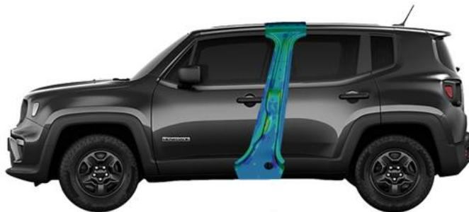
*Figura 6.1 Posizionamento del montante centrale all'interno del BiW dell'autovettura*
