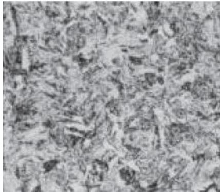
*Figura 3.8* Microstruttura acciaio martensitico temprato [15]
