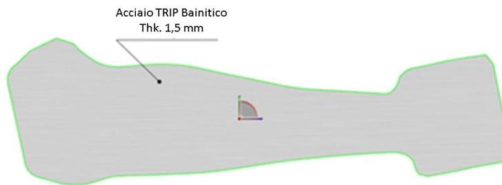
*Figura 6.52 Blank nel caso studio del processo di SmartForm*
