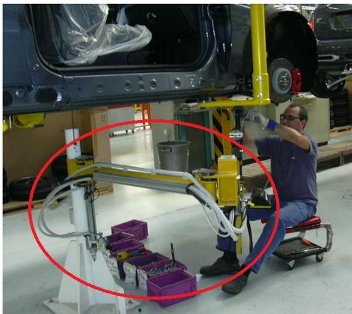
Figura 89- Esempio di utilizzo di avvitatore elettronico con barra di reazione
