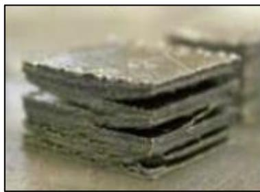
Figura 8: Esempio di componente prodotto mediante AM delaminato [3].
