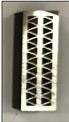
*Figura 18: Rappresentazione campione con canali conformali sezionato lungo piano XZ.*
