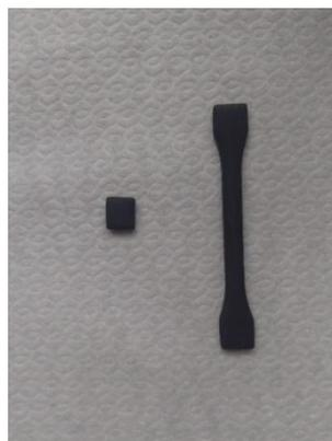
**Figura 3.9** Provino per prove di densità e conducibilità elettrica (a sinistra) e provino per prove di trazione (a destra) prodotti per SLS
