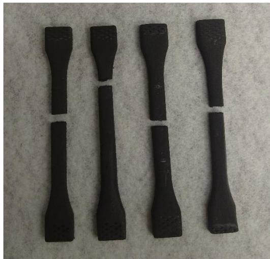
**Figura 4.25** Quattro provini di trazione relativi al provino “P4,9” della composizione 5CF/15G dopo la prova.
