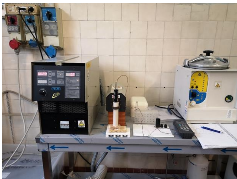
Figura 7.8 – Generatore Felmi serie EGMA6 utilizzato per le prove calorimetriche.
