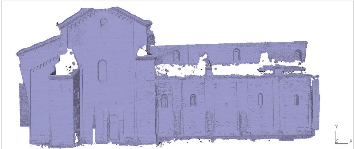
Fig. 4.7 Modello 3D del prospetto nord
