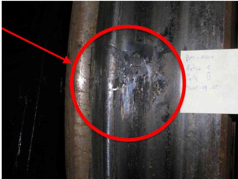
**Figura 1.6 – Ruota sottoposta a un forte pattinamento**
