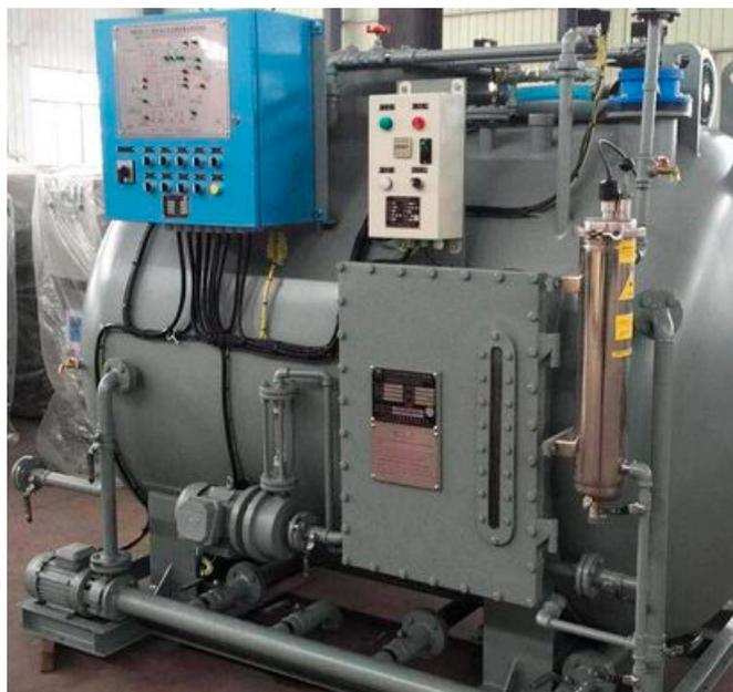
Figura 7.6. Impianto di trattamento acque reflue([42])
