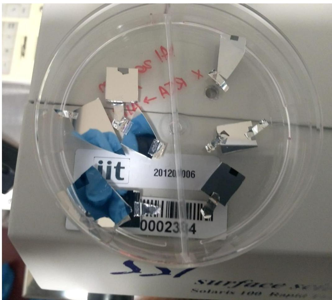
Figura 4.5.1.2. Campioni di Alluminio puro (1) a sinistra prima del trattamento termico (2) a destra dopo il trattamento termico
