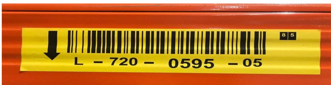
Figura 3. 6 codice univoco di posizione pallet (fonte: foto scattata in azienda)
