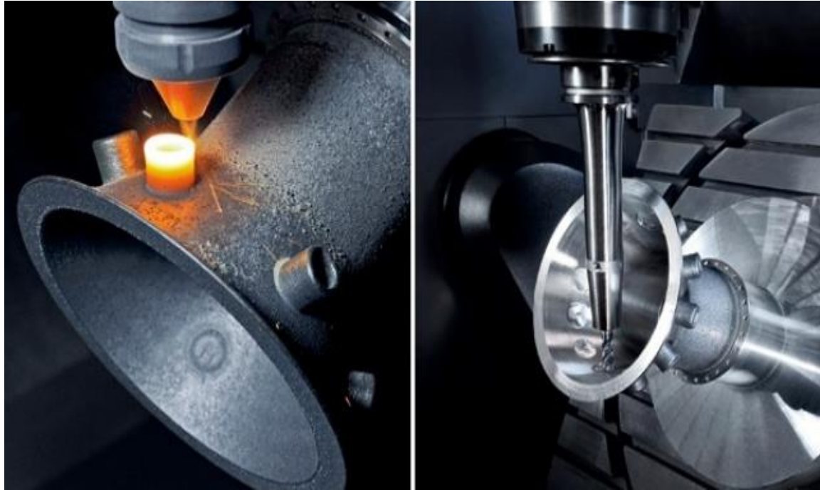
Figura 19 Macchinario ibrido “multitasking” (Fonte:www.dmgmori.com)
