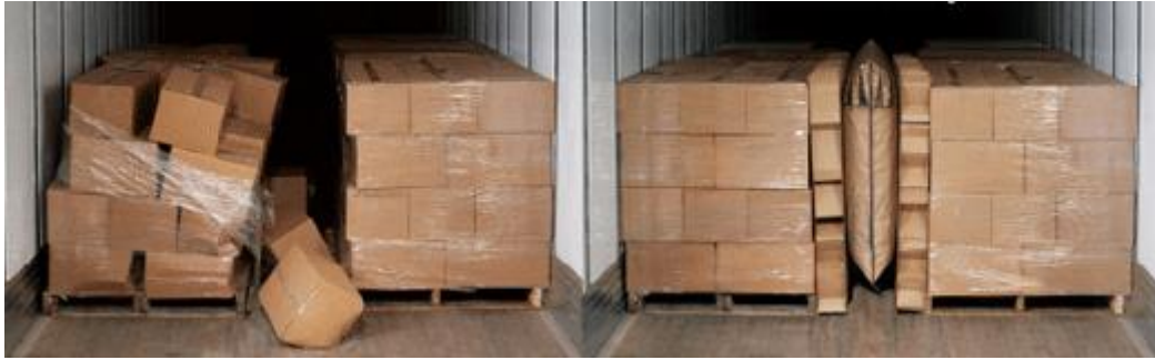
Figura 52 Carico messo in sicurezza (destra) e carico non in sicurezza (sinistra) (Fonte: www.totalpack.in )
