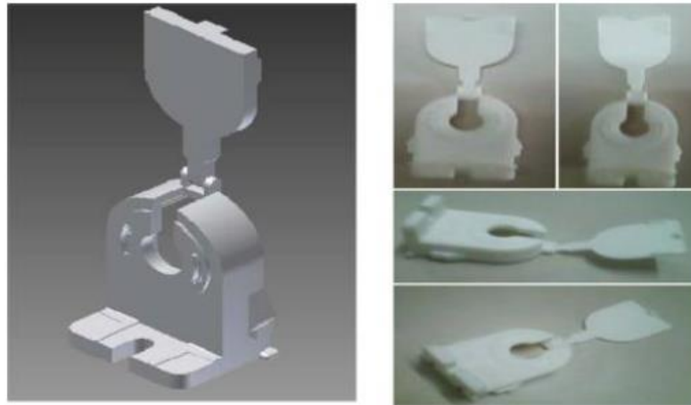
Figura 30 Portalampada riprogettato con tecniche VE (Fonte: Sunil Kumar Tiwari et al.,2015)
