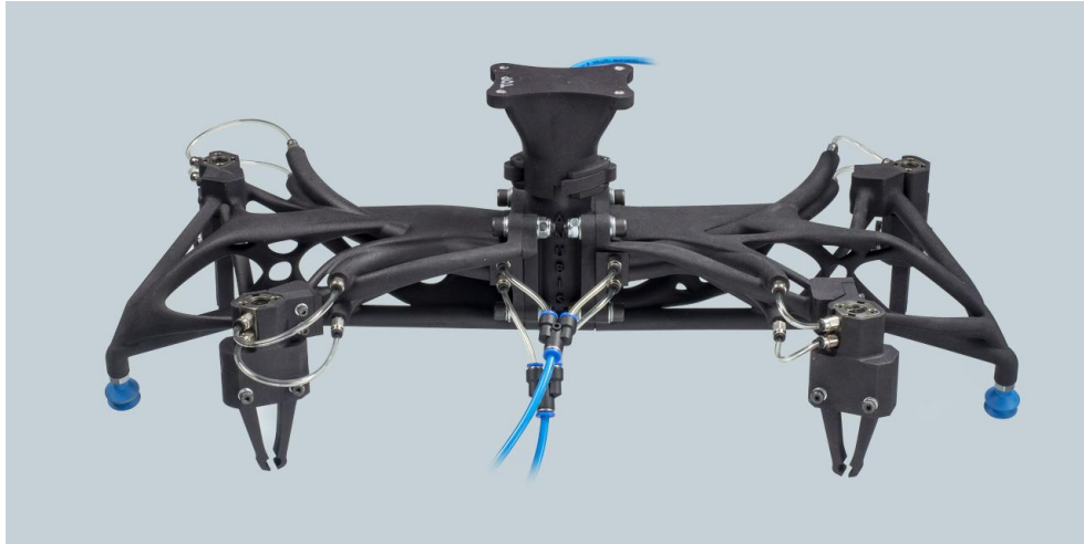
Figura 22 EOAT realizzati tramite stampa 3D (Fonte: www.anubis3d.com )
