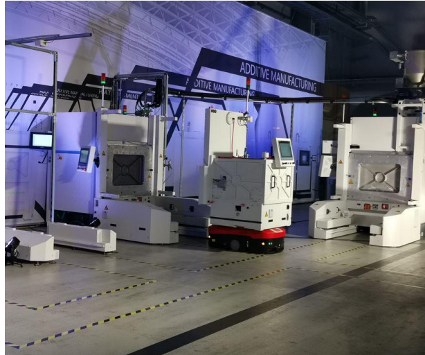
Figura 18 Linea produttiva automatizzata NextGenAM (Fonte: www.eos.com )
