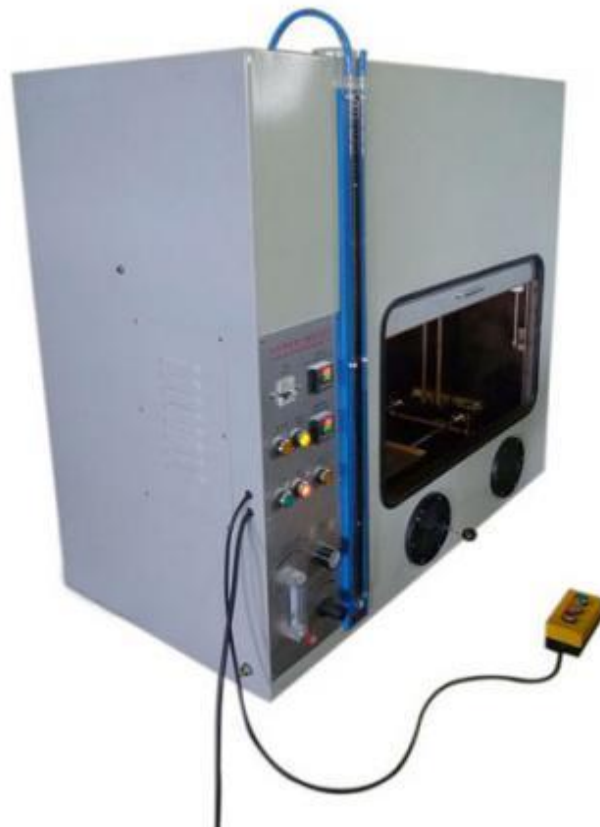
Figura 41 Apparecchiatura usata per i test di infiammabilità [28].
