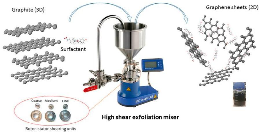
Figura 32: Schema del processo di esfoliazione mediante miscelazione ad alta velocità
