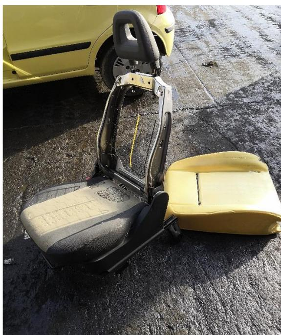
Figura 22: Sedile anteriore smontato
