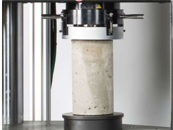
Figura 20 Pressa per caratterizzare il calcestruzzo
