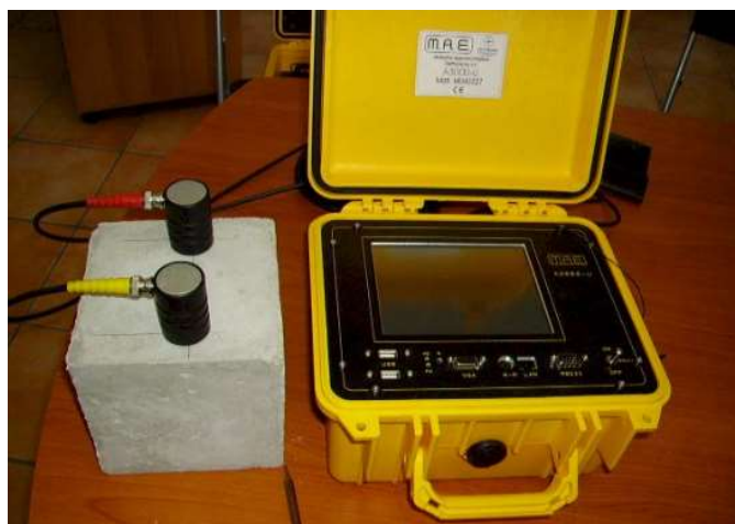
Figura 14 Strumentazione per indagine ultrasonica
