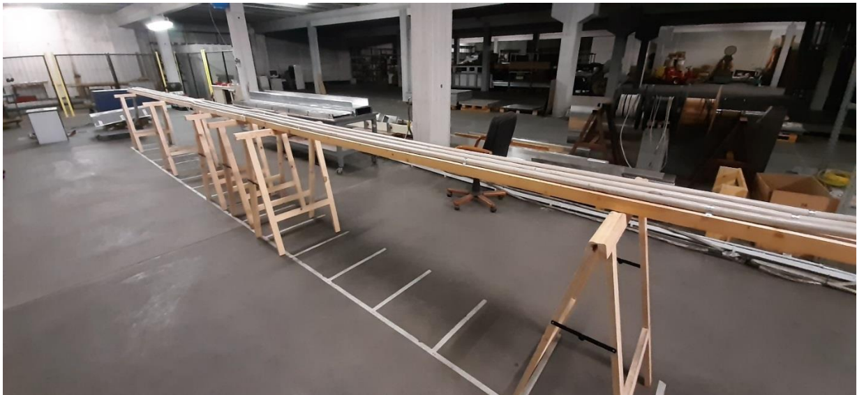
Figura 4 Struttura della sorgente per l'emissione di campo magnetico: sono state realizzate sul terreno delle linee di riferimento per il posizionamento della sonda nelle successive misure effettuate.
