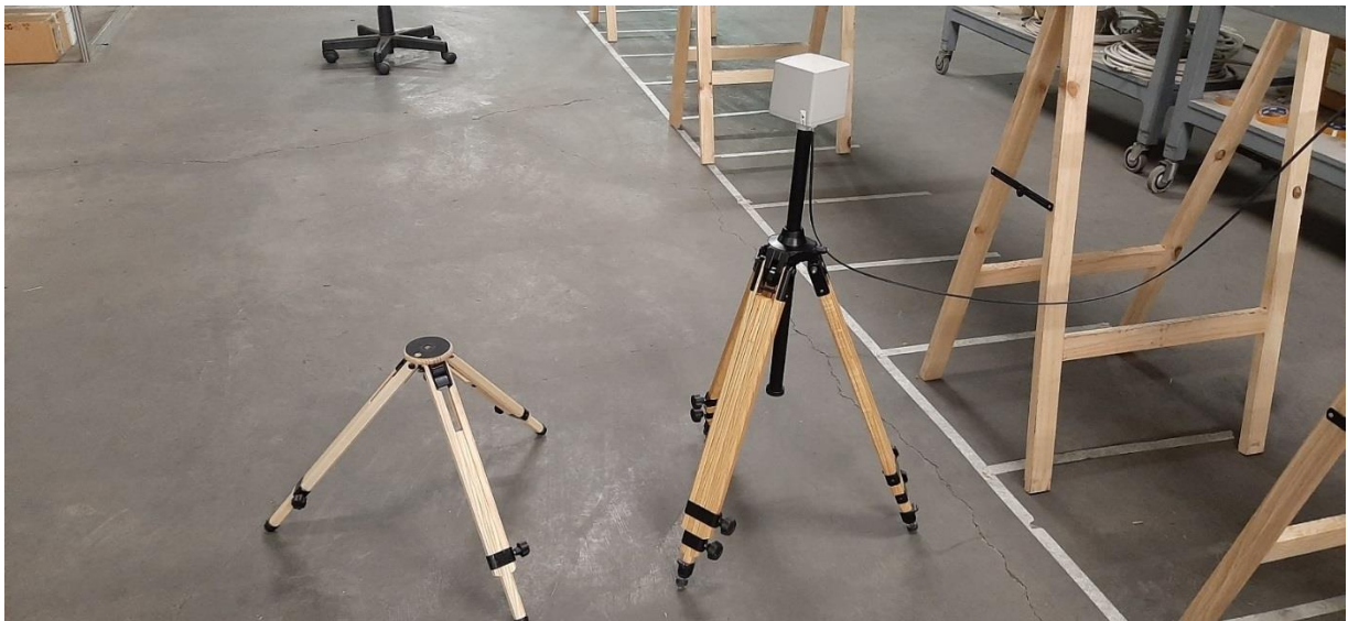
Figura 11 Esempio di posizionamento sulle diverse altezze dei cavalletti ausiliari al fine delle misure sulla superficie inferiore del canale.
