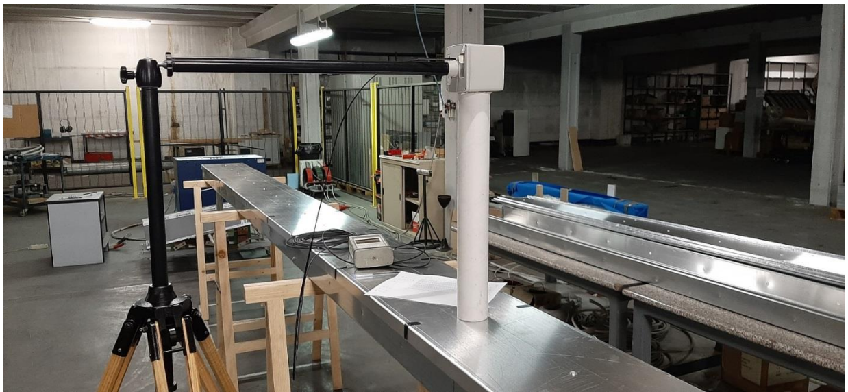
Figura 9 Particolare del posizionamento della sonda durante la misurazione delle grandezze sulla superficie superiore mediante supporto ausiliario sagomato.
