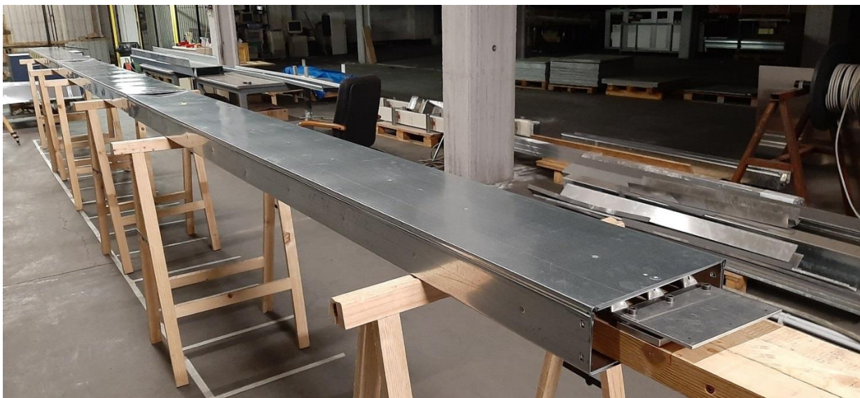
Figura 5 Sorgente di campo magnetico inglobata nel canale schermante. Si può notare il collegamento ai terminali dei conduttori che li pone in condizione di corto circuito. Si nota inoltre che il canale termina in corrispondenza dei giunti in corto circuito e no
