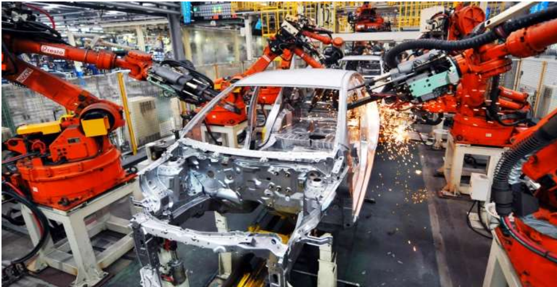
Figura 3 - robot che eseguono lavorazioni sulla scocca di un'auto (fonte: http://www.chimicaweb.com/ )
