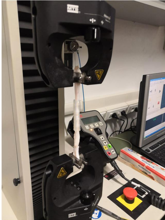
Figura 5.26: *MTS Insight<sup>®</sup> Electromechanical Testing Systems* durante un test di trazione su tendine suino con geometria del dispositivo adattata presso il Laboratorio di Nanomeccanica Bio-ispirata "Giuseppe Maria Pugno".
