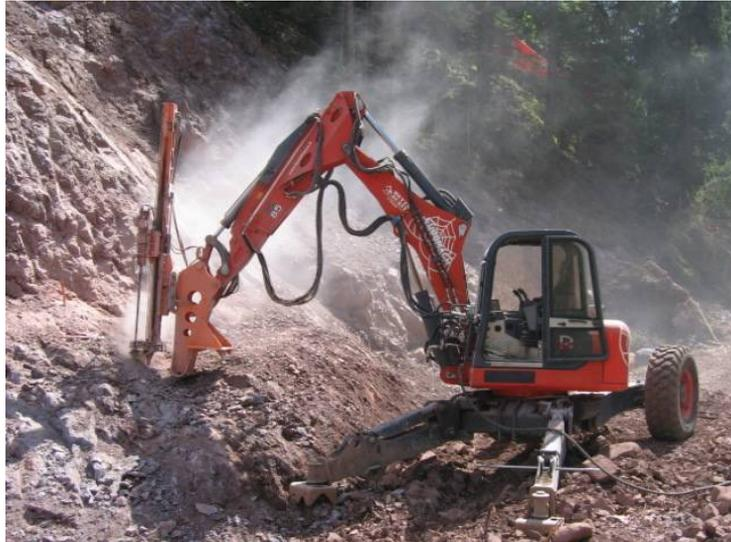
**Figura 14** Un ragno con ruote e perforatrice installata (Foto da: <http://www.bettafranco.it>)
