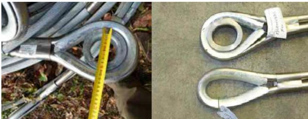
**Figura 13** A sinistra l'asola rinforzata, a destra le deformazioni differenti tra asola rinforzata o meno (Foto da: Simonini et al, 2014)
