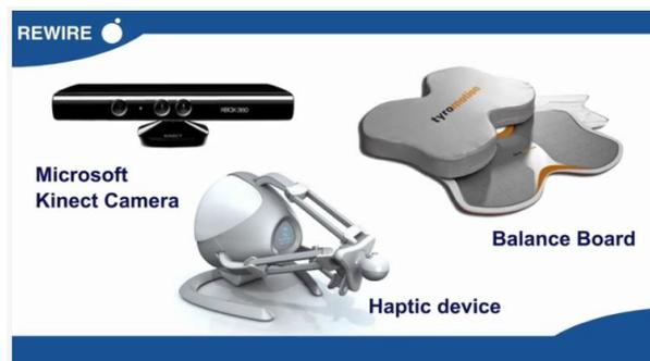
*Figura 2. 2 Strumenti utilizzati in REWIRE [36]*
