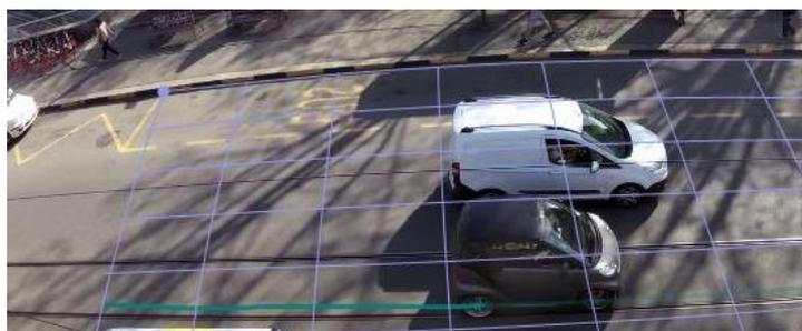
**Figure 50. Sovrapposizione dei veicoli e impossibilità di tracciare la traiettoria per l'utente posto in secondo piano.**
