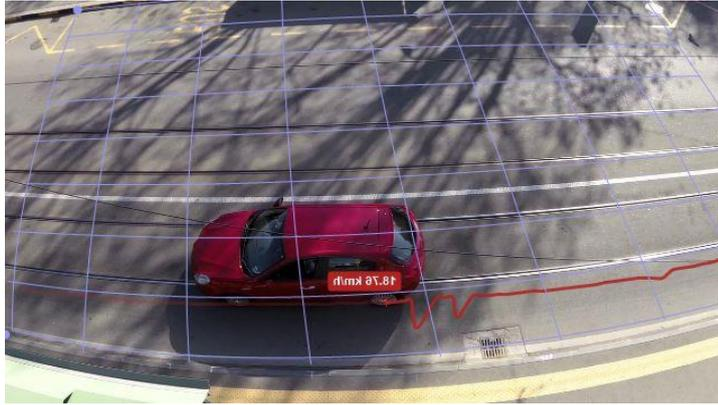
Figure 51. Salti durante il tracciamento della traiettoria, a causa della rotaia
