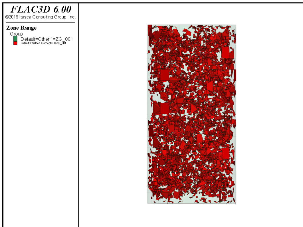
Figura 115. Elementi plasticizzati a taglio relativi alla modellazione eterogenea delle prova Tx_310_ML.
