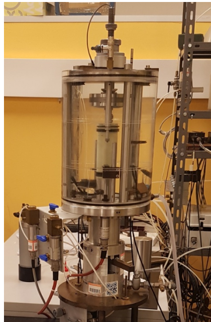
Figura 4. Apparecchiatura triassiale del Politecnico di Torino.
