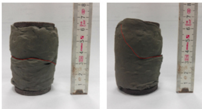
Figura 17. Deformazione globale a fine prova del provino eterogeneo con VBP=30%.
