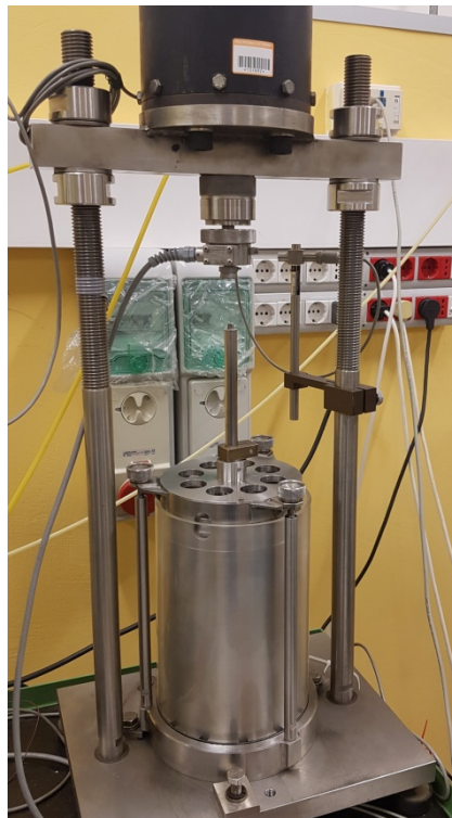
Figura 5. Consolidometro del Politecnico di Torino.
