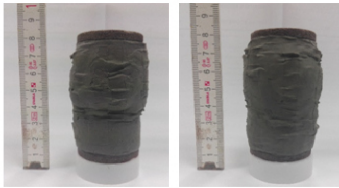
Figura 18. Deformazione globale a fine prova del provino eterogeneo con VBP=50%.
