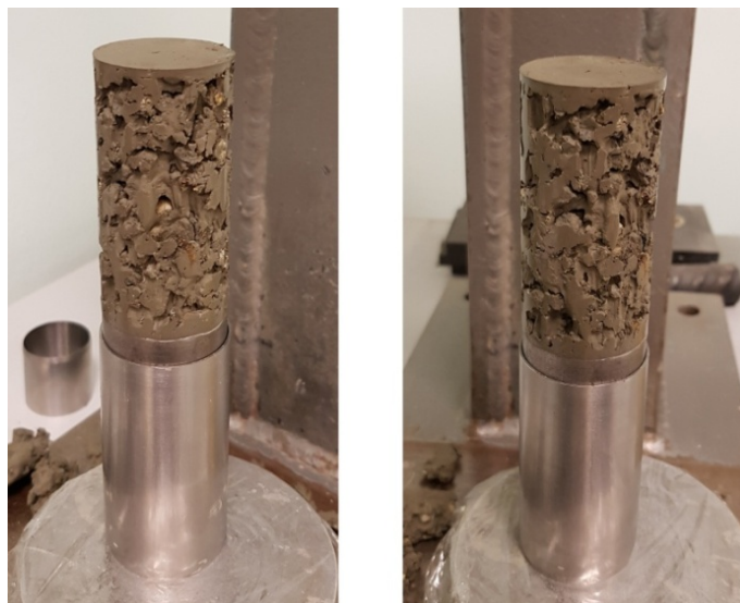
Figura 7. Provini di materiale eterogenei dopo l'infissione della fustella.
