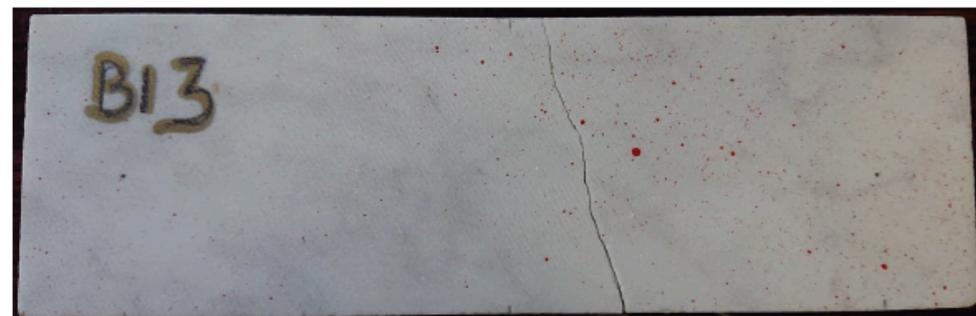
Figura 20 Rottura del campione post prova di flessione su 3 punti.
