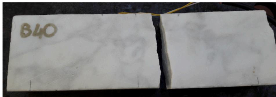
Figura 16 Rottura del campione post prova di flessione su 4 punti.
