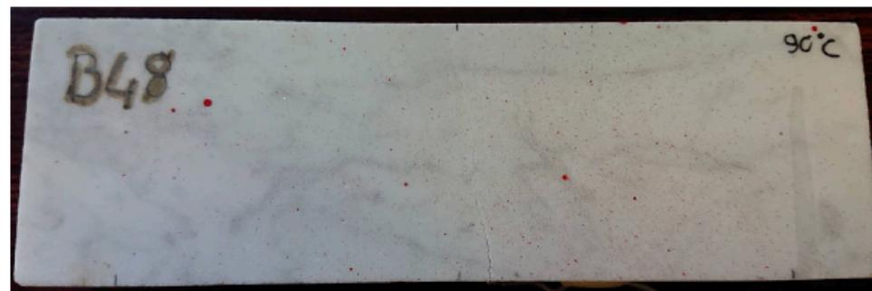
Figura 27 Rottura del campione post prova di flessione su 3 punti.
