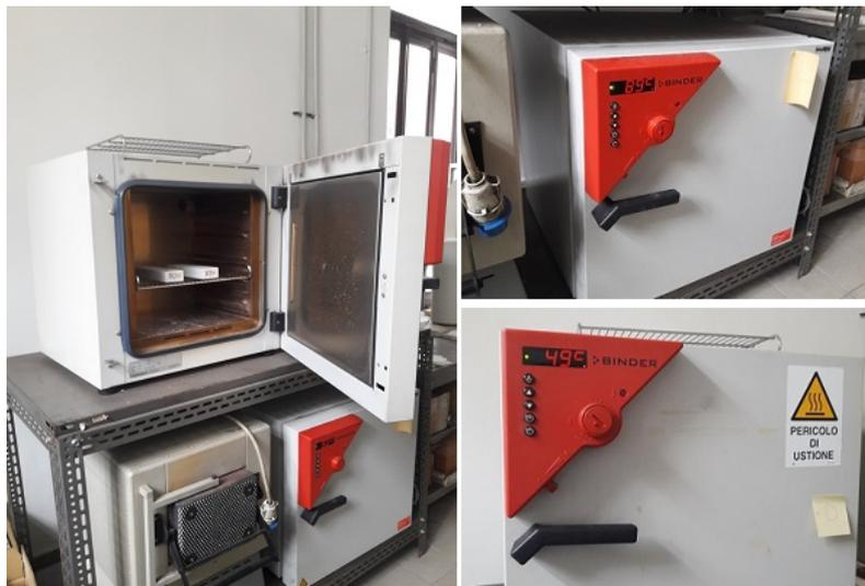
Figura 26 Alloggiamento provini nel forno per riscaldamento a 50/90°C
