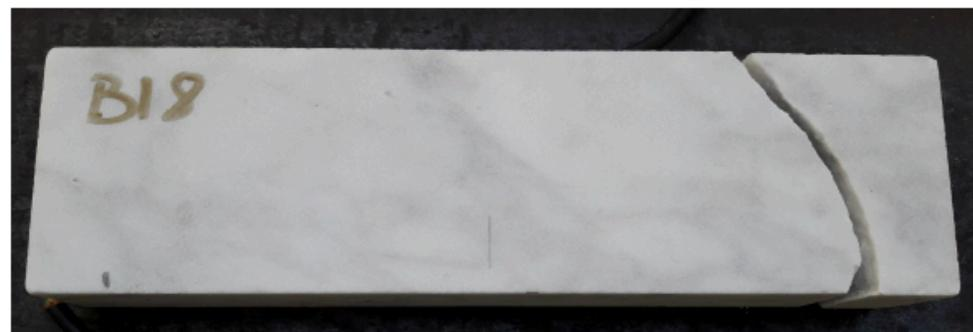
Figura 12 Rottura del campione post prova di flessione su 4 punti.
