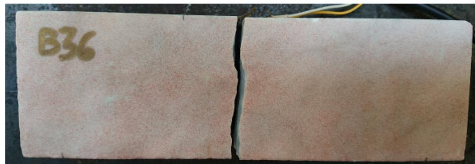
Figura 15 Rottura del campione post prova di flessione su 4 punti.
