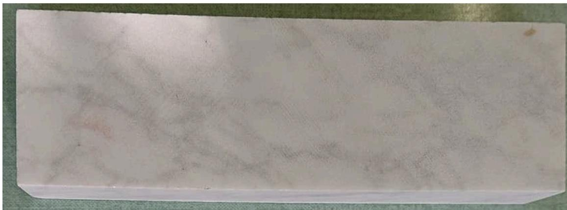
*Figura 30 Immagine di una faccia del provino B6 successivamente il trattamento chimico.*
