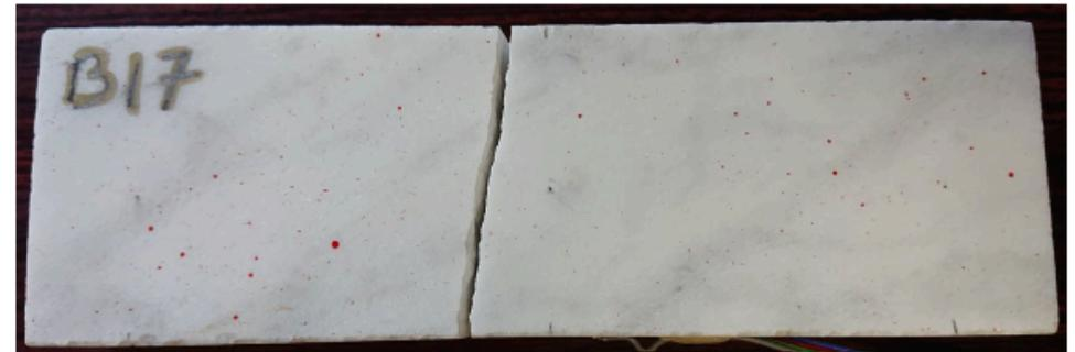
Figura 23 Rottura del campione post prova di flessione su 3 punti.
