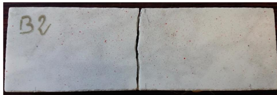
Figura 17 Rottura del campione post prova di flessione su 3 punti.
