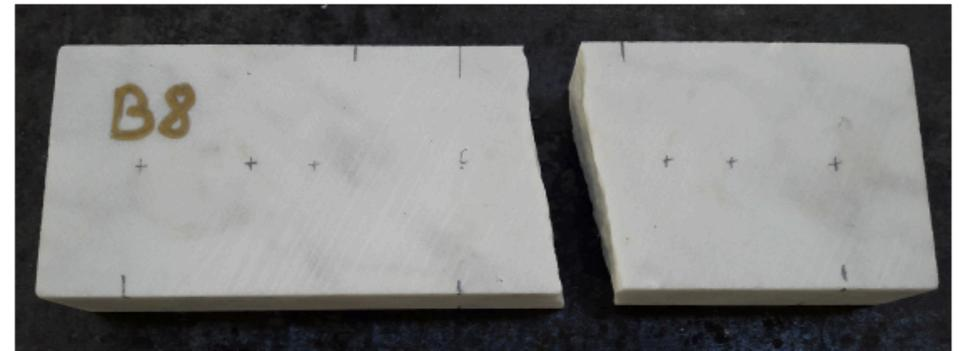
Figura 5 Rottura del campione post prova di flessione su 4 punti.
