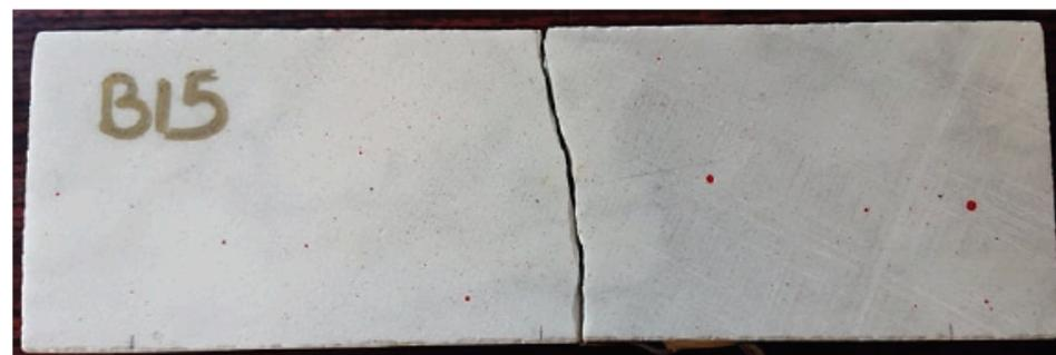
Figura 22 Rottura del campione post prova di flessione su 3 punti.
