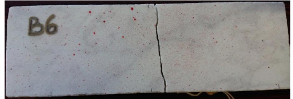
Figura 25 Rottura del campione post prova di flessione su 3 punti.
