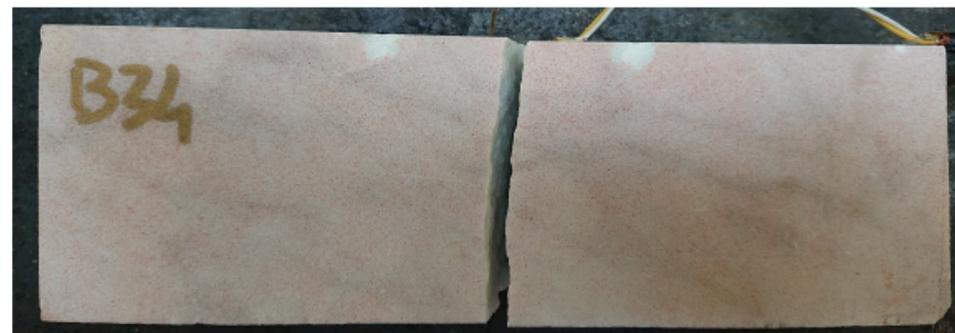
Figura 14 Rottura del campione post prova di flessione su 4 punti.
