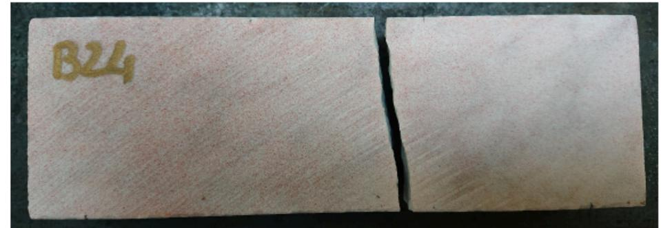
Figura 13 Rottura del campione post prova di flessione su 4 punti.
