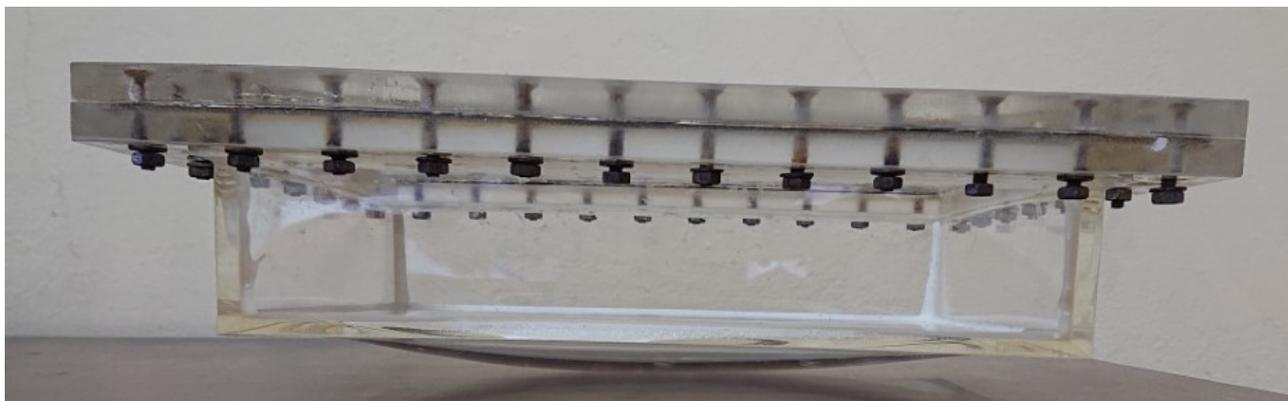
*Figura 31 Incurvatura della superficie inferiore del contenitore, dovuta alle sovrappressioni generate dal prodotto della reazione.*
