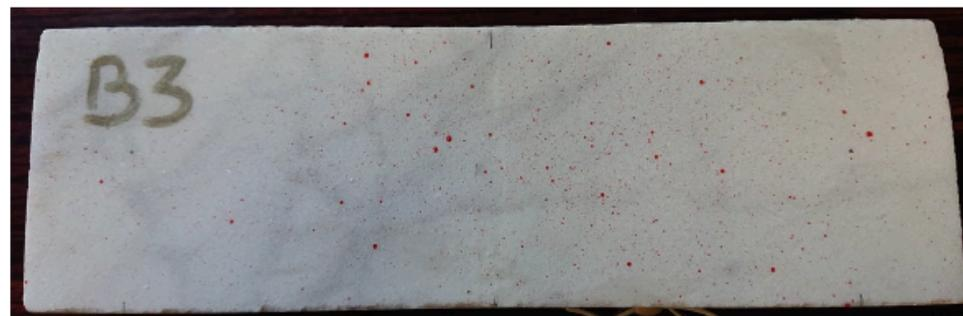
Figura 18 Rottura del campione post prova di flessione su 3 punti.
