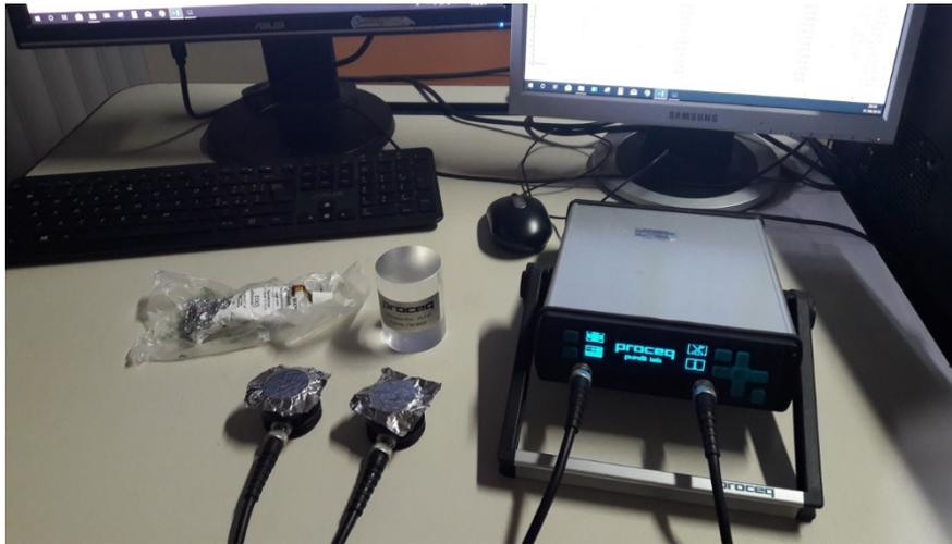
Figura 12 Strumentazione utilizzata per la misura della resistività elettrica (PunditLab®)
