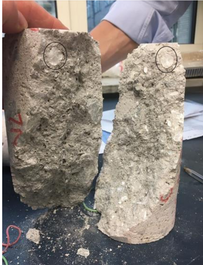
Figura 3.9: rottura carota galleria N2T
