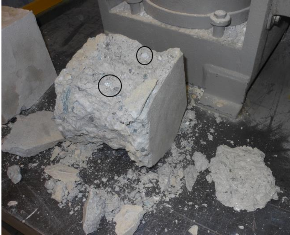
Figura 3.2: rottura campione a 28 giorni con evidente taglio dei grani di talco
