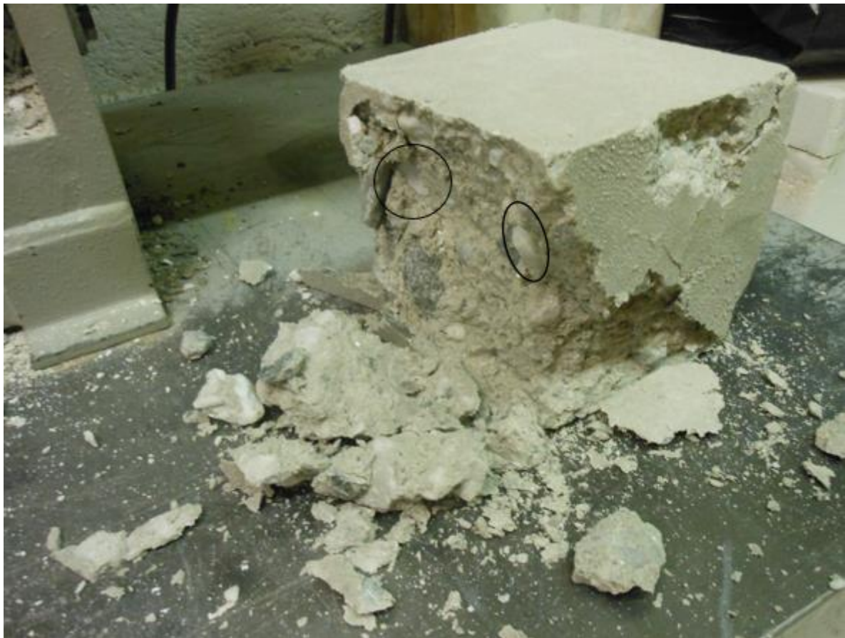
Figura 3.1: rottura campione a 28 giorni con evidente taglio dei grani di talco
