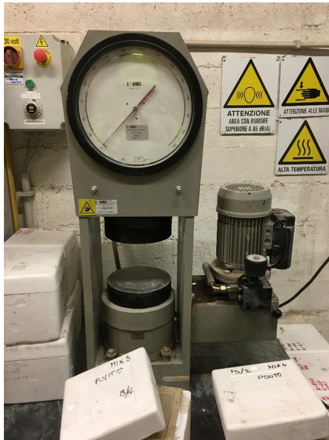
Figura 2.4: macchina per il test di compressione monoassiale utilizzata
