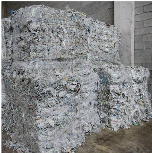
**Figura 1.19** – Sottoprodotto del processo di estrazione della cellulosa dal materiale proveniente dalla raccolta differenziata della carta, a seguito del processo di asciugatura meccanica [33].
