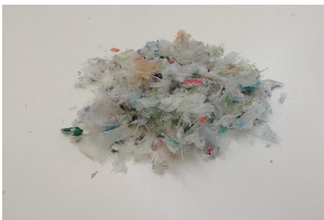
**Figura 1.25** – Materiale del flusso principale prima della densificazione.
