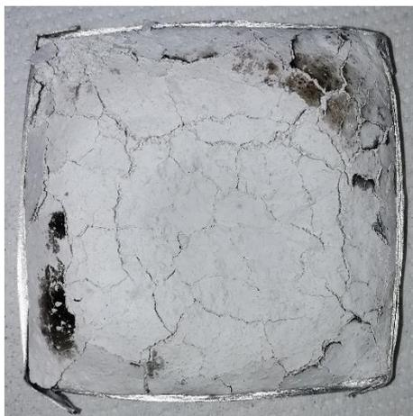
**Figura 3.72** – Superficie di provino di PEAL60MH al termine della prova al cono calorimetro.
