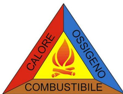
Figura 1.29 – Triangolo di fuoco nel caso di materiali standard [75].
