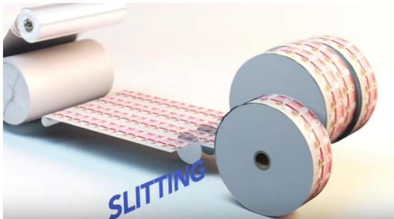
**Figura 1.15** – Estratto del video rappresentativo della produzione del poliaccoppiato. In particolare, taglio della bobina principale in bobine di dimensioni inferiori. Estratto del video [45].
