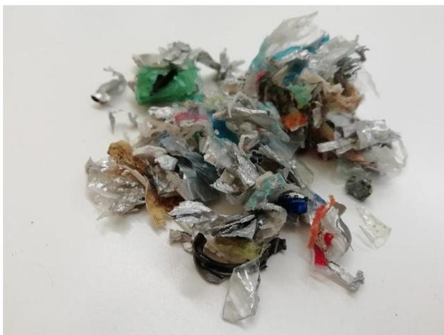
**Figura 1.24** – Materiale misto di scarto ottenuto a seguito della separazione in vasca di decantazione
