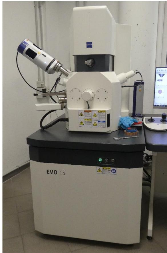
**Figura 2.7** – SEM EVO 15 con ottica ZEISS.
