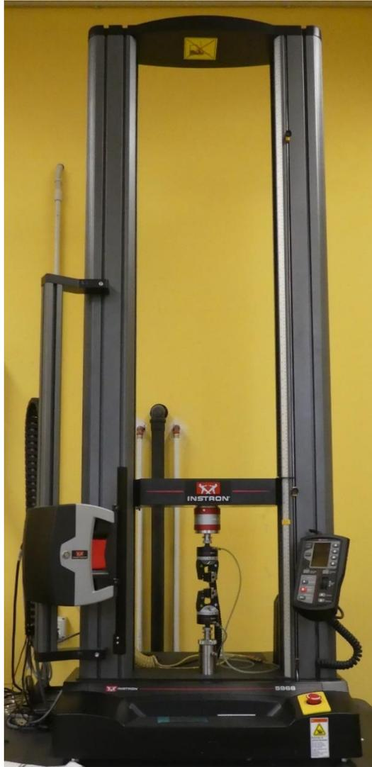
**Figura 2.15** – Dinamometro Instron modello 5966.
