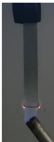
**Figura 3.70** – Dettaglio della prova UL-94 in configurazione verticale del PEAL60MH. L'immagine ritrae il provino durante la prima esposizione alla fiamma.
