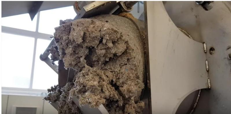
**Figura 1.18** – Fibre di cellulosa all'uscita del selezionatore Trommel. Estratto dal video [57].
