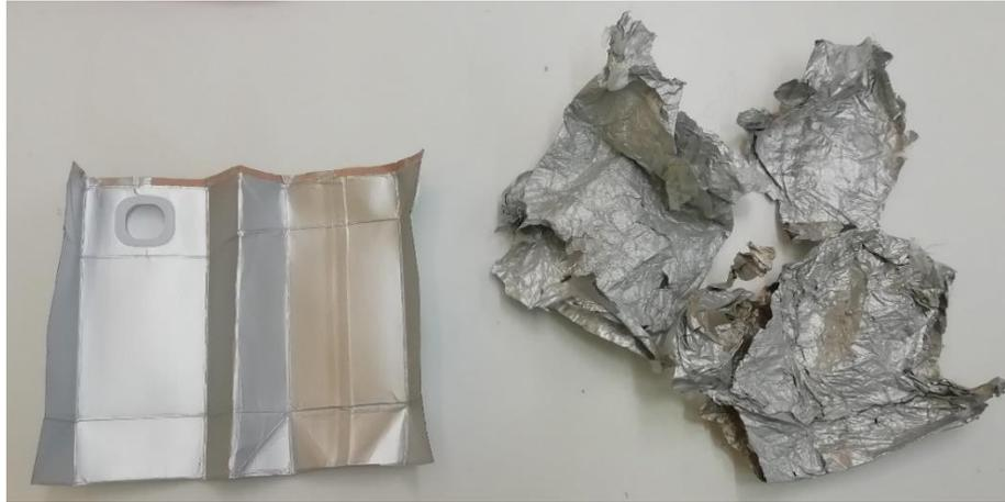
**Figura 1.22** – Confronto tra una confezione per bevande in IPC aperta (sinistra) ed il sottoprodotto ottenuto dal processo di eliminazione delle fibre di cellulosa fatto in cartiera
