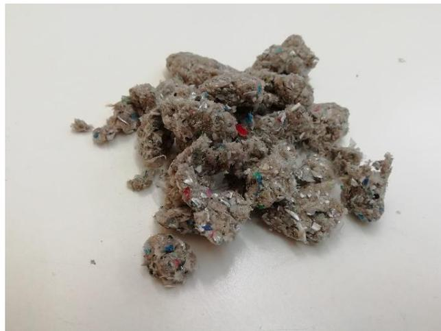
**Figura 1.23** – Cellulosa ottenuta dal processo di separazione
