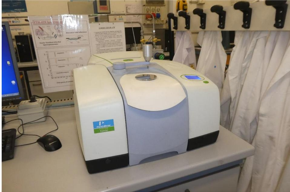
**Figura 2.6** – Spettrofotometro FTIR-ATR Perkin Elmer-Frontier.
