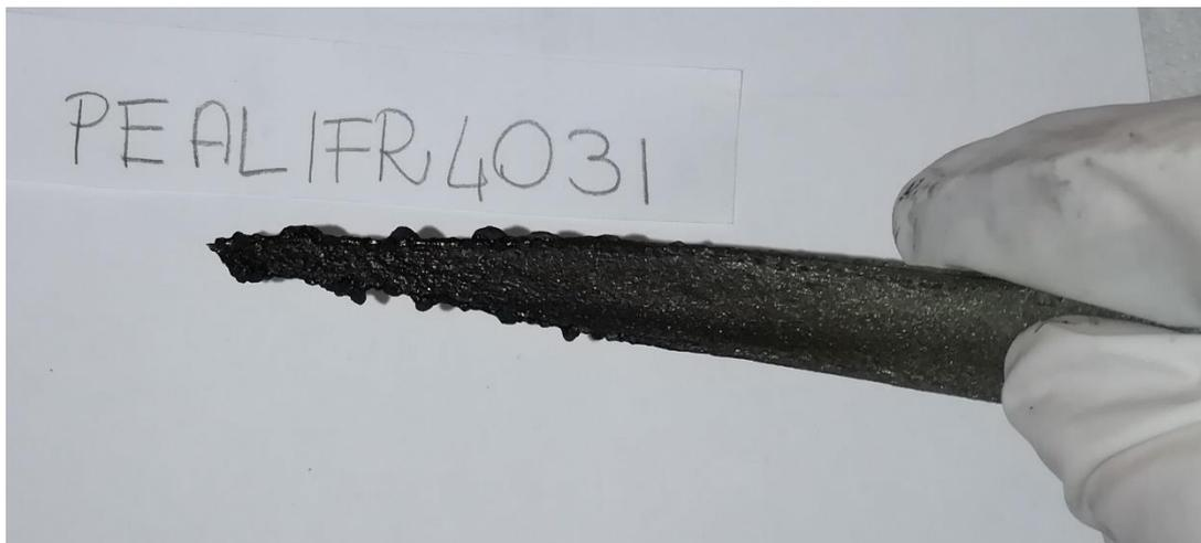
**Figura 3.42** – Residuo del provino di PEALIFR4031 al termine della prova di combustione UL-94 verticale. Nella parte sinistra della figura si possono vedere le bolle tipiche del comportamento intumescente.
