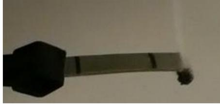
**Figura 3.39** - Dettaglio di prova UL-94 in configurazione orizzontale di PEALIFR4031 al termine della combustione. È possibile apprezzare il fumo derivante dallo spegnimento e la “lingua” di char protesa verso il basso.
