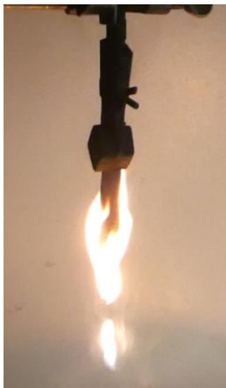
**Figura 3.34** - Particolare della prova di infiammabilità UL-94 verticale del PEALIFR3031. Nell'immagine è raffigurato il provino in combustione nel tratto utile ed una goccia di materiale infuocato in caduta.
