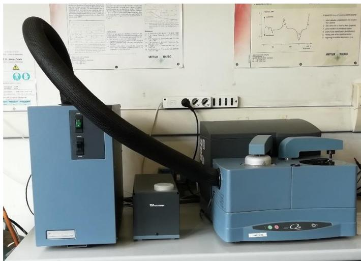
**Figura 2.4** – DSC modello Q20 prodotto dalla TA Instruments.
