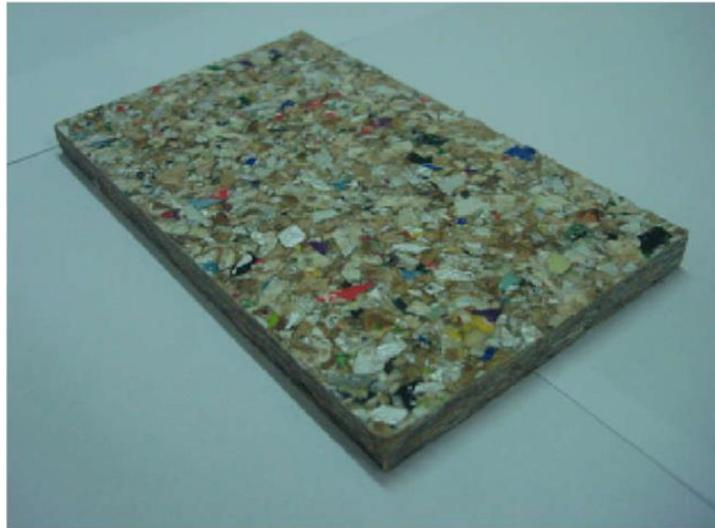
**Figura 1.16** – Pannello Yekpan<sup>®</sup> ottenuto per compressione a caldo di IPC [53].
