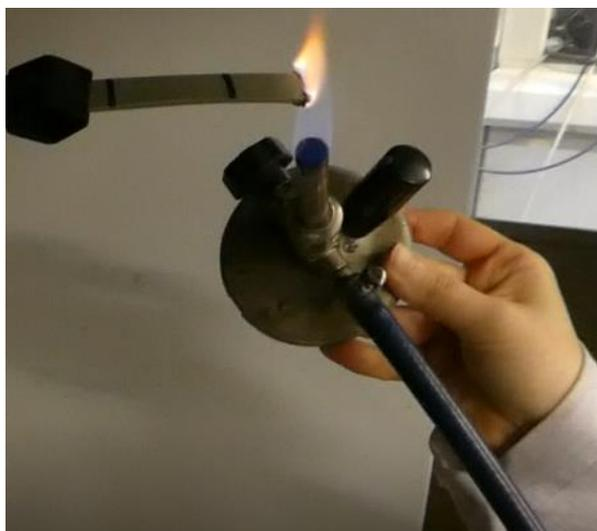
**Figura 3.38** – Dettaglio di prova UL-94 in configurazione orizzontale di PEALIFR4031 durante i 30 secondi di applicazione della fiamma. Si noti la formazione dello strato di residuo carbonioso rigonfiato osservabile nella porzione di provino interessata dalla fiamma.
