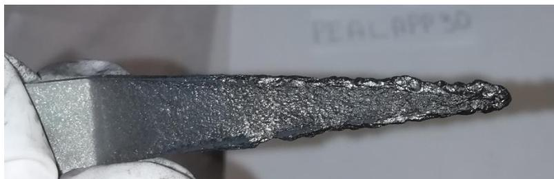
**Figura 3.27** – Residuo di PEALAPP30 a seguito del test di infiammabilità verticale UL-94.
