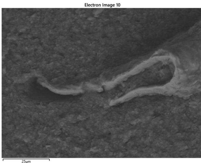
**Figura 3.83** – Immagine SEM-BSD raffigurante la porzione di provino su cui è stata eseguita la mappatura EDX.
