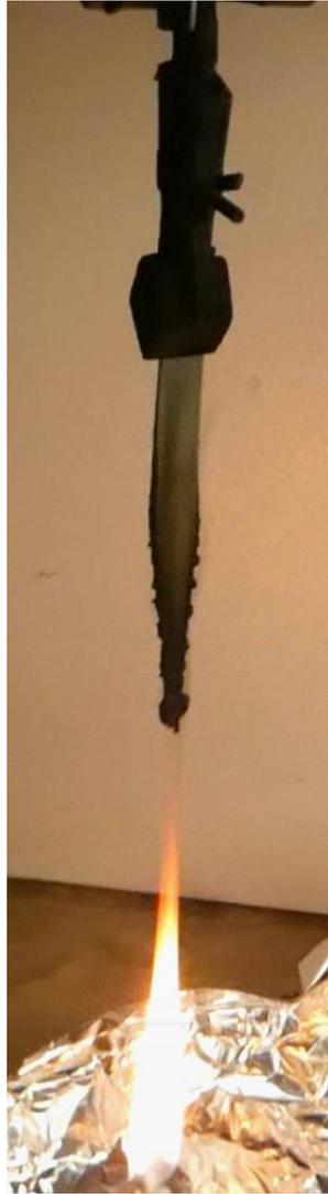
**Figura 3.40** – Dettaglio della prova UL-94 verticale su PEALIFR4031. In figura si può apprezzare l'istante in cui il provino si spegne a seguito del gocciolamento di materiale infuocato.
