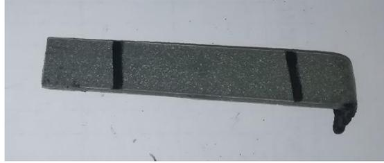
**Figura 3.33** – Provino di PEALIFR3031 a seguito del test di infiammabilità UL-94 orizzontale.
