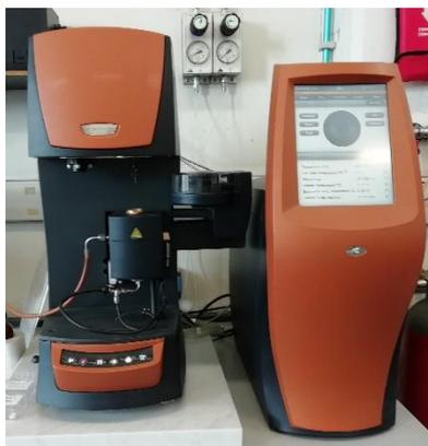
**Figura 2.5** – TGA Discovery prodotta da TA Instruments.
