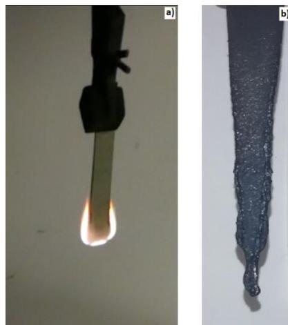
**Figura 3.35** – A sinistra (a)) dettaglio della combustione del PEALIFR3031 in cui è possibile apprezzare la formazione di char; a destra (b)) provino al termine della prova di infiammabilità verticale.
