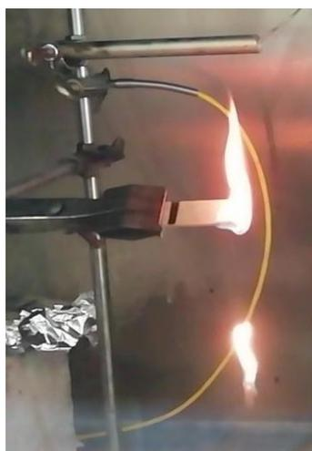
**Figura 3.12** – Particolare della prova di infiammabilità UL-94 orizzontale del PEAL. Nell'immagine è raffigurato il provino in combustione nel tratto utile ed una goccia di materiale infuocato in caduta.
