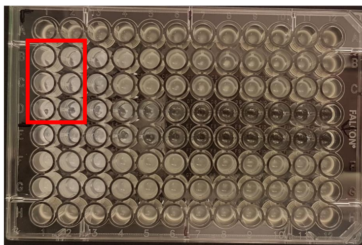
Figura 3.20: piastra multiwell da 96 pozzetti in cui è stato testato lo ZnO di sintesi con S.epidermidis .
