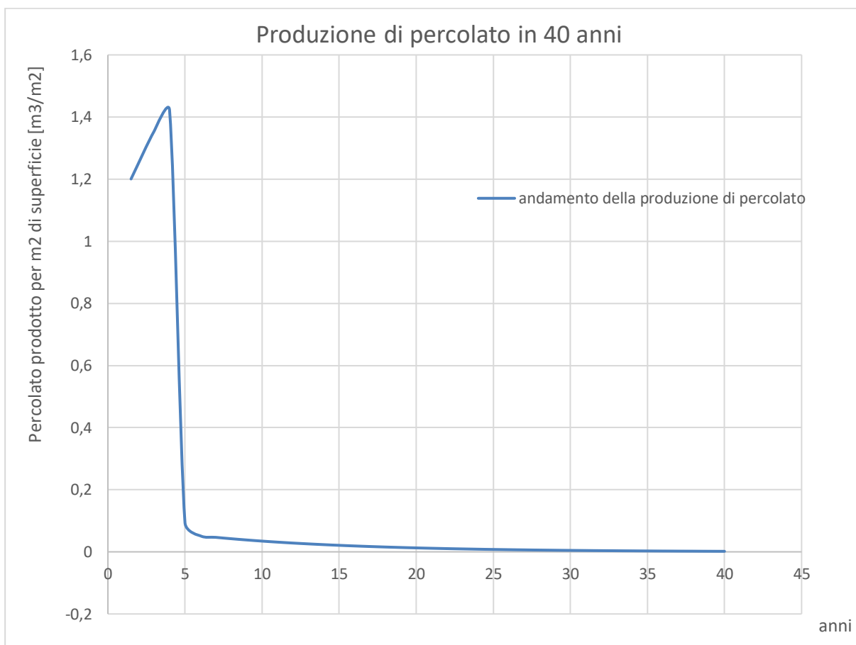
Figura 4.15: gestione anaerobica, andamento della produzione di percolato per m 2 di superficie in 40 anni
