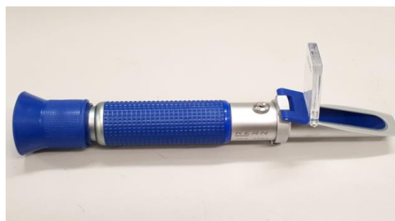
Figura 2.3: rifrattometro utilizzato per il calcolo del contenuto di zuccheri
