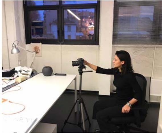
Misurazione della distribuzione di luminanze tramite videoluminanzometro in corrispondenza di una postazione di lavoro.
