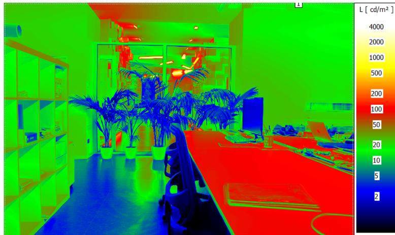
Figura 2 – Esempio di acquisizione in falsi di colori della distribuzione di luminanza all'interno di un locale.
