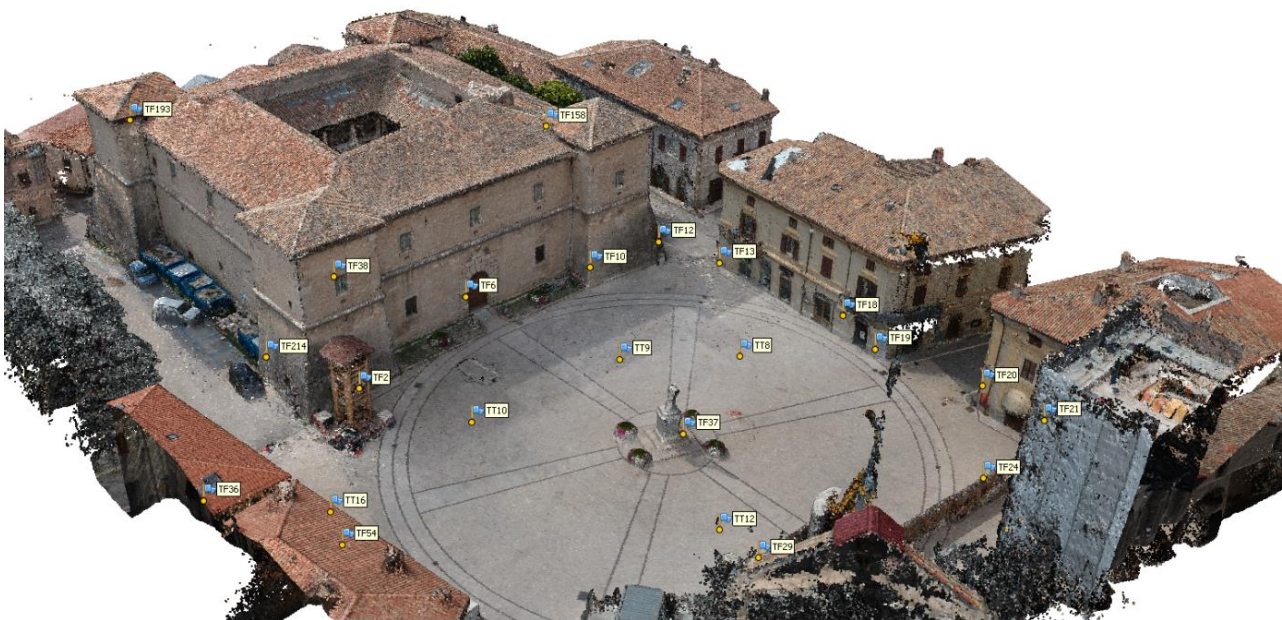
Figura 1: Nuvola di punti densa della piazza S.Benedetto di Norcia (10.444.874 punti) – Agisoft Photoscan.
